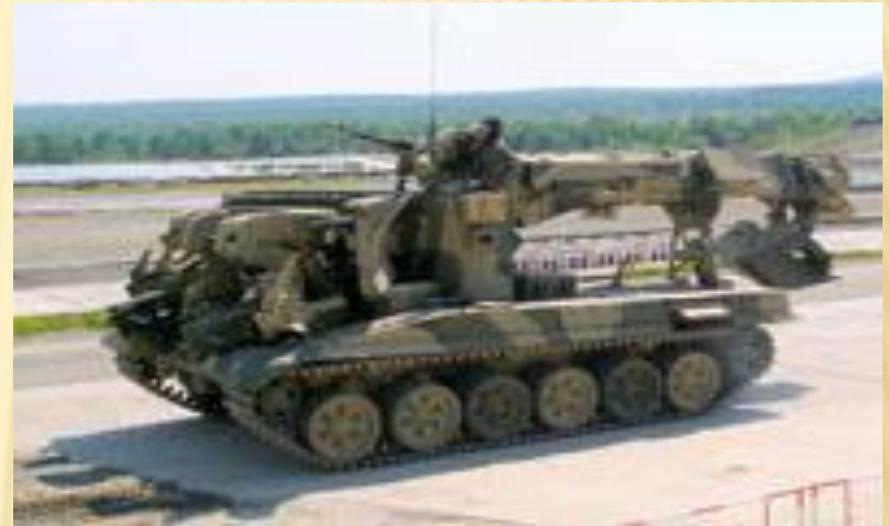
Инженерная машина разграждения ИМР-2 предназначена для обеспечения продвижения войск путем оборудования колонных путей в труднопроходимых условиях (лесные завалы и разрушения после бомбардировок и применения ядерного оружия) и проходов в минных полях в сложной боевой и погодно-климатической обстановке.
