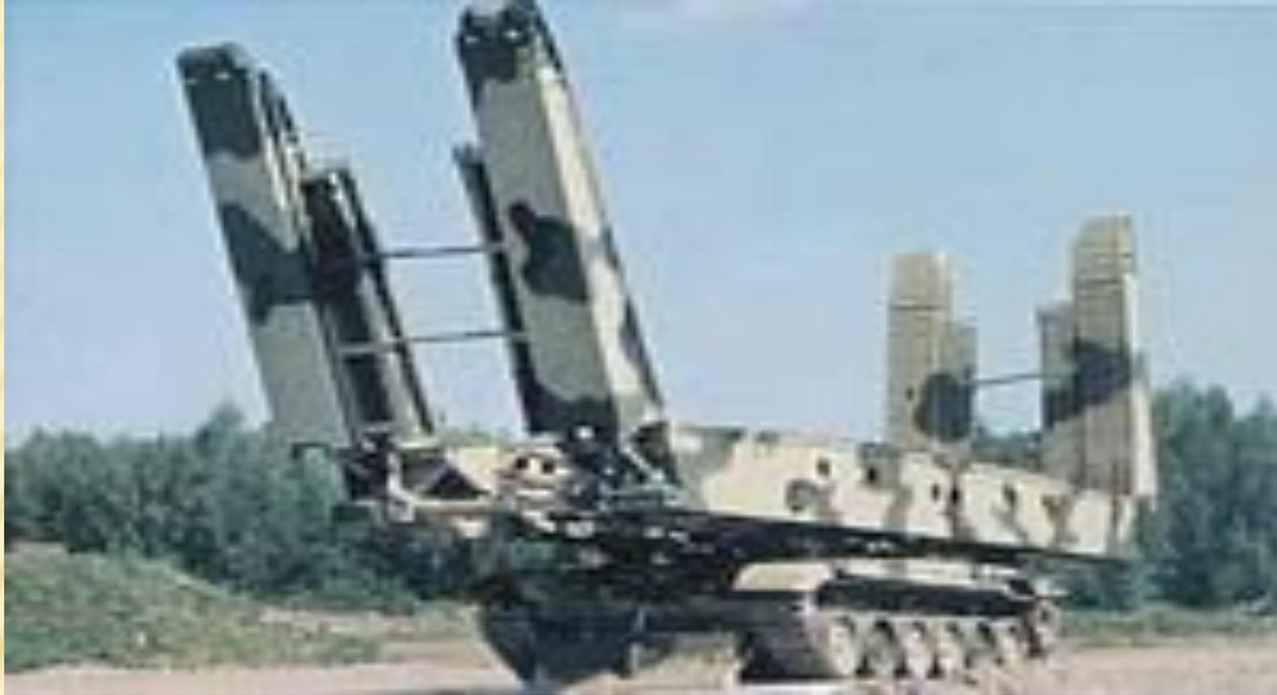
Танковый мостокладчик МТУ-72 предназначен для наведения однопролетного металлического моста грузоподъемностью 50 тонн через препятствия шириной до 18 метров. Его место в боевых порядках второго эшелона танкового полка или в первом эшелоне танковой дивизии. Наведение моста осуществляется экипажем машины без выхода личного состава из машины.
