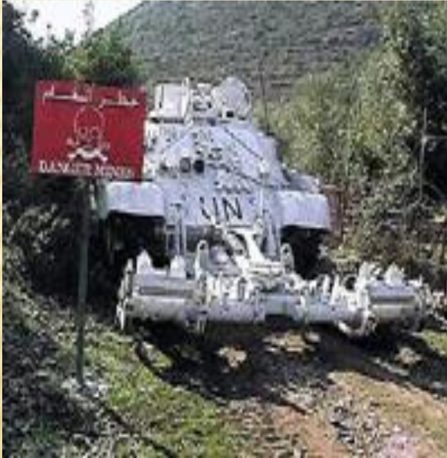
Средства преодоления минно-взрывных заграждений включают в себя средства траления и средства взрывного разминирования.
