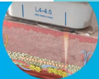
Вместо хирургического скальпеля аппарат ULTRAFORMER использует высокоинтенсивный сфокусированный ультразвук.
