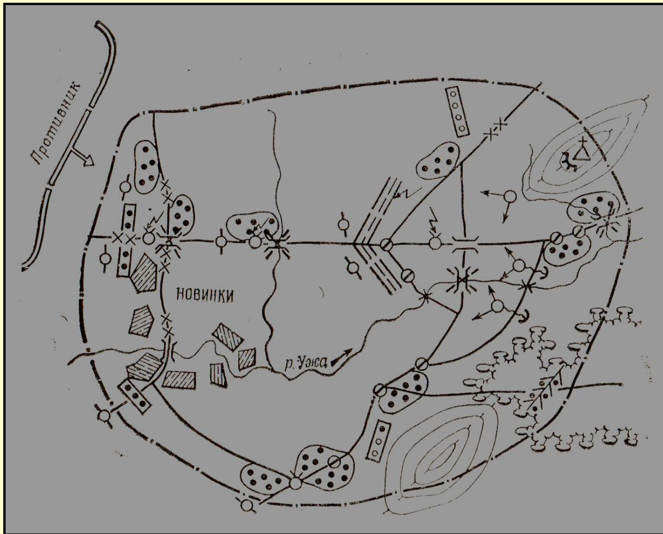
Рис. 7. Узел заграждений на дорожном направлении на среднeperесеченной местности
