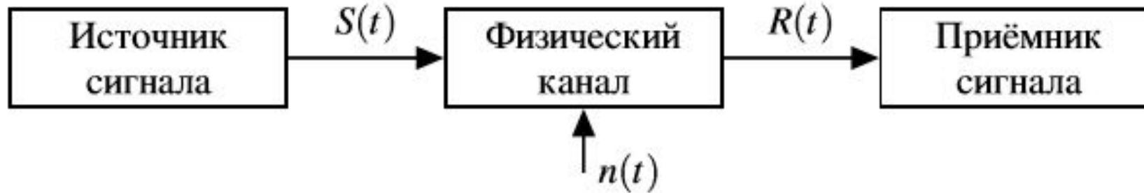
Рис.1. Структурная схема физического канала в общем виде
