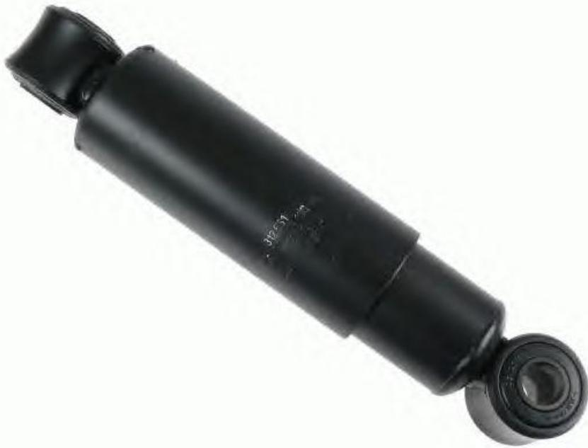
*Двухтрубные амортизаторы* имеют рабочий цилиндр и резервуар, жидкость и воздух в них соприкасаются между собой, а внутреннее давление воздуха составляет 0,08...0,1 МПа.
