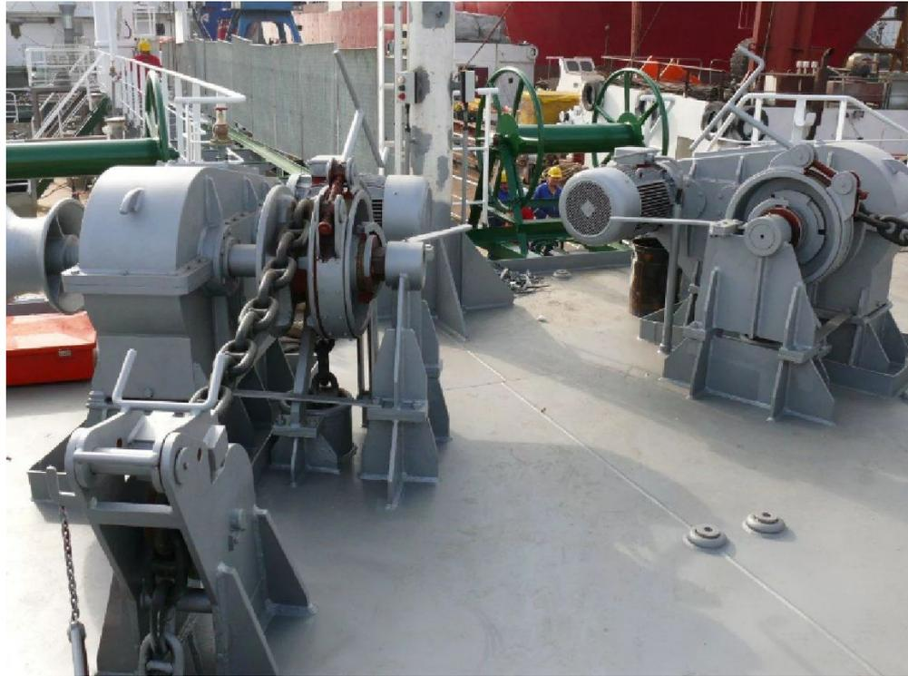
Механизмы, входящие в состав судовых устройств и расположенные в большинстве случаев на палубах, их принято называть палубными вспомогательными механизмами. Они приводятся в действие электрическими или электрогидравлическими машинами.
