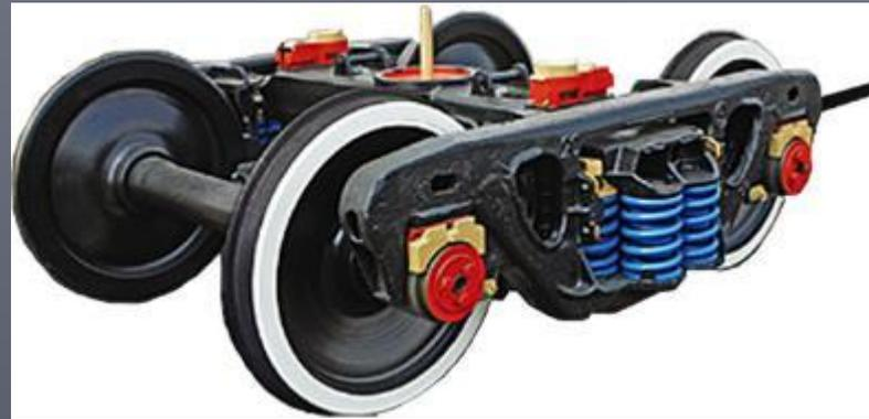
Тележка состоит из двух колесных пар, четырех букс 1, двух литых боковых рам 2, двух комплектов центрального рессорного подвешивания 5 и 6, литой наддресорной балки 3 и тормозной рычажной передачи 8, 9.
