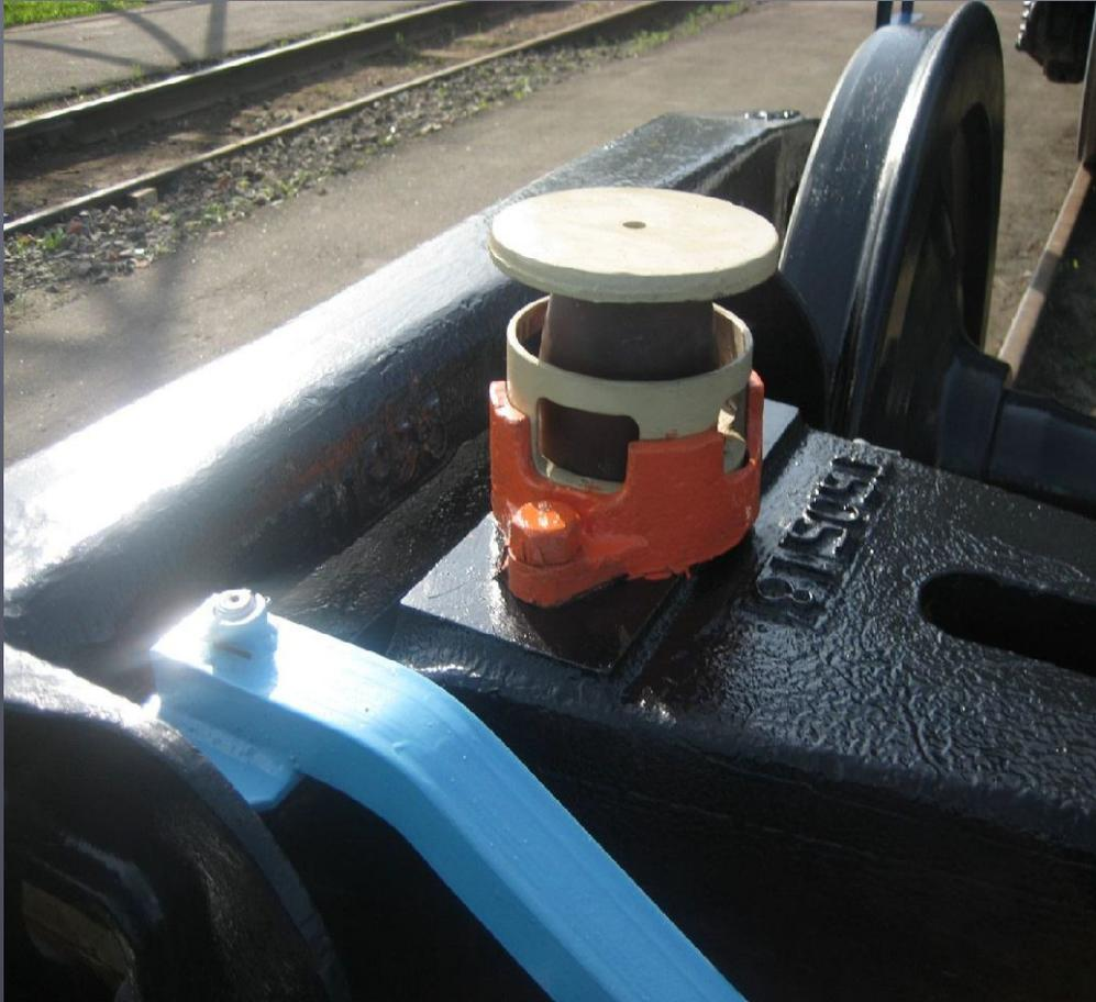
Подобные упругие скользуны применяются на тележках модели 18-194-1 . Они также состоят из закрепленного на надрессорной балке стального корпуса, упругого элемента из морозостойкой резины и опорной площадки (подобие колпака) из высокопрочного чугуна. Как видно из рисунка, корпус данного скользуна выполнен облегченным.
