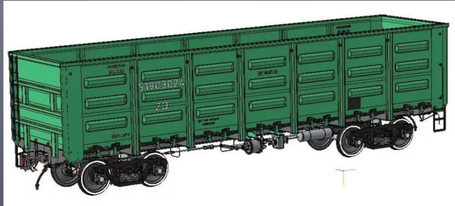
**1.К ходовым частям** относятся тележки с колесными парами, буксами, подшипниками, пружинами. Ходовые части должны обеспечивать движение вагона по рельсовому пути с необходимой плавностью и наименьшим сопротивлением движению.
