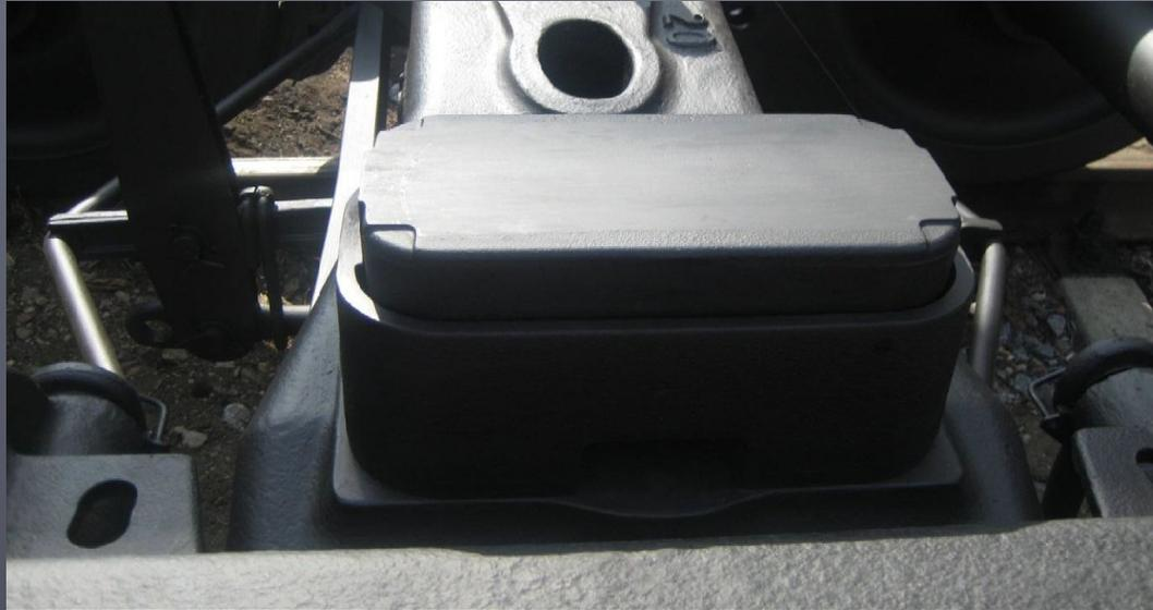
Модели «американских» тележек (18-9810; 18-9836; 18-9855) укомплектованы скользунами постоянного контакта. Тележки типа «Barber S-2-R» (модели 18-9810 и 18-9855) имеют идентичные скользуну SBR 20 компании «Standard Car Truck», которые представляют собой закрепленный на надрессорной балке при помощи двух болтов массивный стальной корпус, в котором находятся две двухрядные пружины, на которые опирается массивный колпак из высокопрочного чугуна. При этом пружины в корпусе не закреплены..
