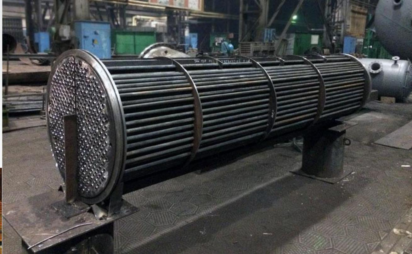
По своей сути, трубные пучки для аппаратов теплообменных характеризуются достаточно простой конструкцией и являются набором трубных поперечно-ребренных плетей, которые прочно скреплены посредством крепкого каркаса
