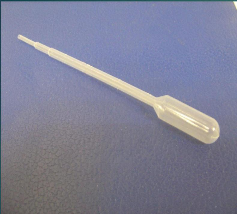
Пипетка — мерный или дозирующий сосуд, представляющий собой трубку, либо ёмкость с трубкой, имеющую конец (наконечник, кончик, носик) с небольшим отверстием, для ограничения скорости вытекания жидкости.
