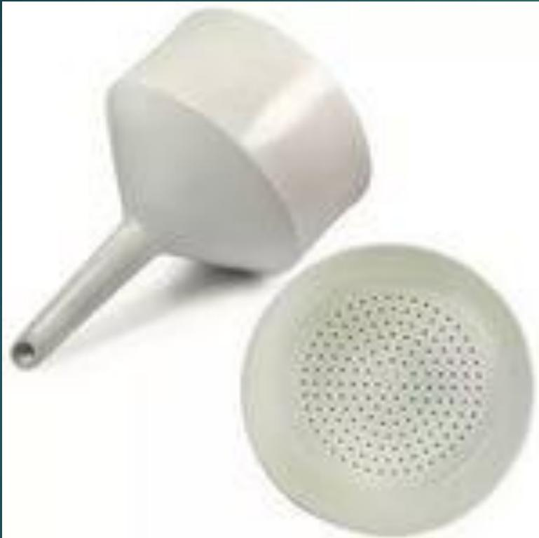
Предназначена для фильтрации под вакуумом, традиционно выполняется чаще всего из фарфора, реже — из металла или пластмасс. Верхняя часть воронки, в которую наливают жидкость, пористой или перфорированной перегородкой отделена от нижней части, к которой подведён вакуум.
