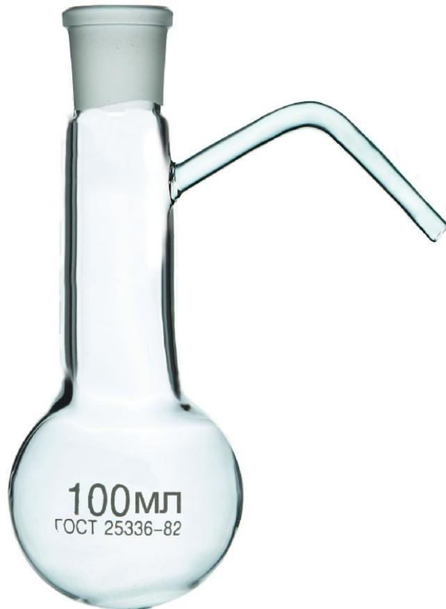
Колба Вюрца- это круглодонные колбы с длинным горлом, от которого отходит под углом длинная узкая отводная трубка.
