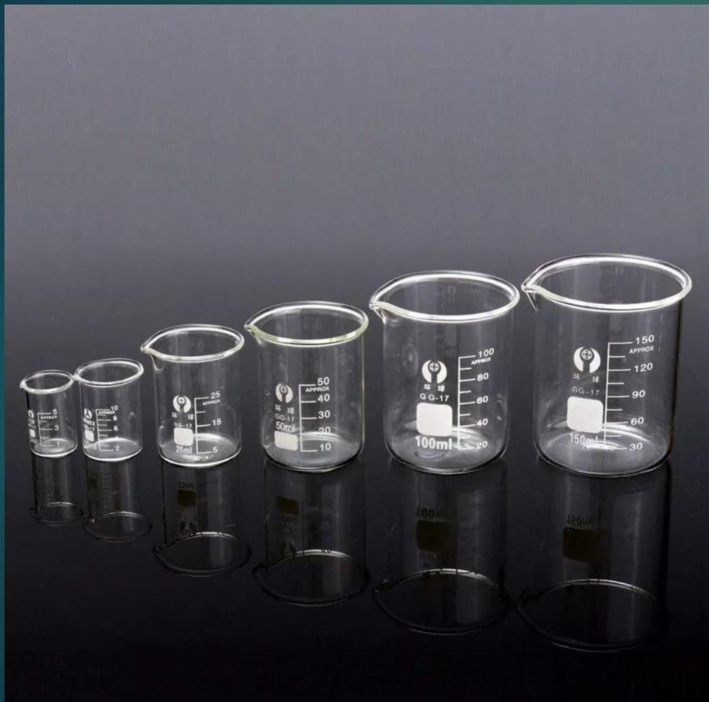
Химический стакан — вид лабораторной посуды, тонкостенная цилиндрическая ёмкость с плоским дном.
