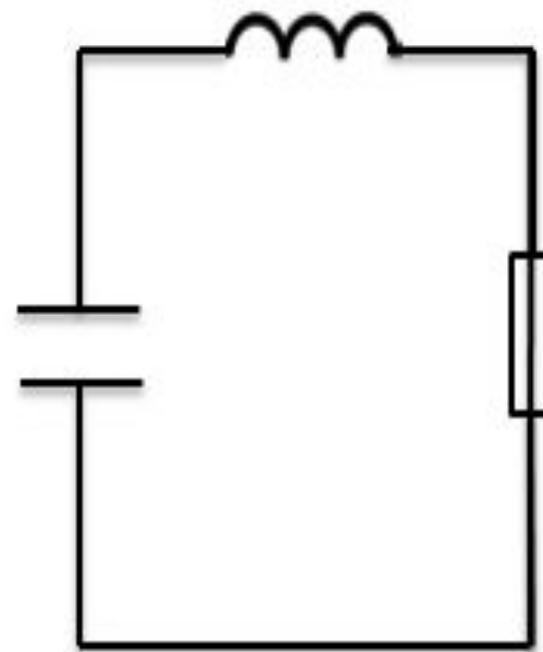
Колебательной системой, в которой можно создать электромагнитные колебания, является *колебательный контур*.
