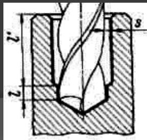
В отверстиях, обрабатываемых более точно (зенкерованием, растачиванием, развертыванием), необходимо сверление углублено в днище отверстия на глубину  $l$ , достаточную для выхода режущего конуса зенкера, что позволяет выдержать заданную длину  $l$  чистовой обработки. Диаметр сверления определяется величиной припуска  $s$  на эту обработку.
