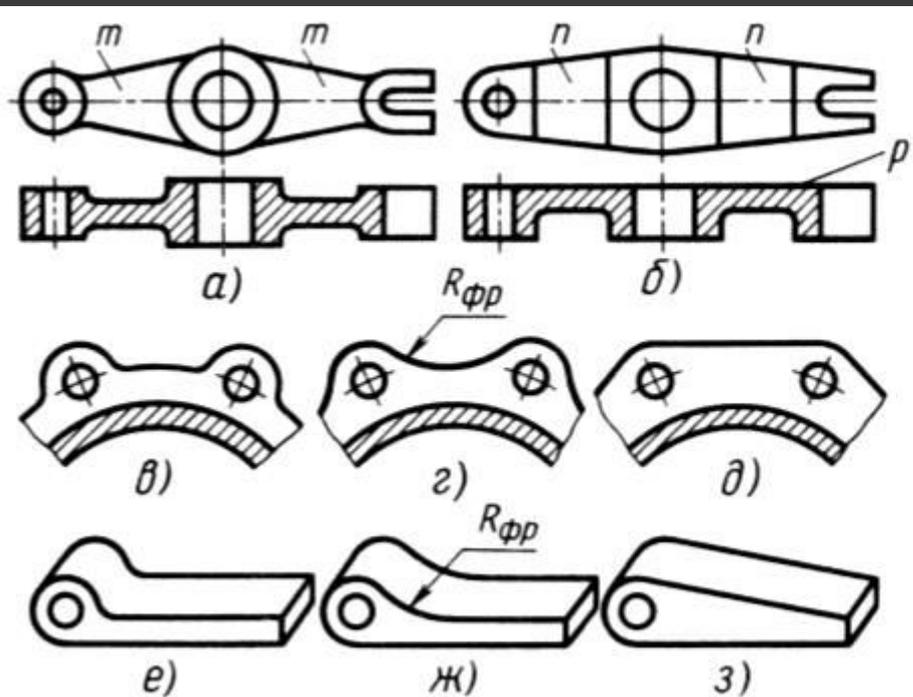
В конструкции б наружный контур описан прямыми линиями и окружностями и поддается копирному фрезерованию. Фрезеровать контур фланца (вид в) практически невозможно из-за малых галтелей у основания бобышек. Участки между бобышками должны быть профилированы радиусом, по меньшей мере равным радиусу фрезы (вид г), или прямыми линиями (вид д). е – неправильная, ж, з – правильные конструкции рычага, подвергаемого круговому фрезерованию.
