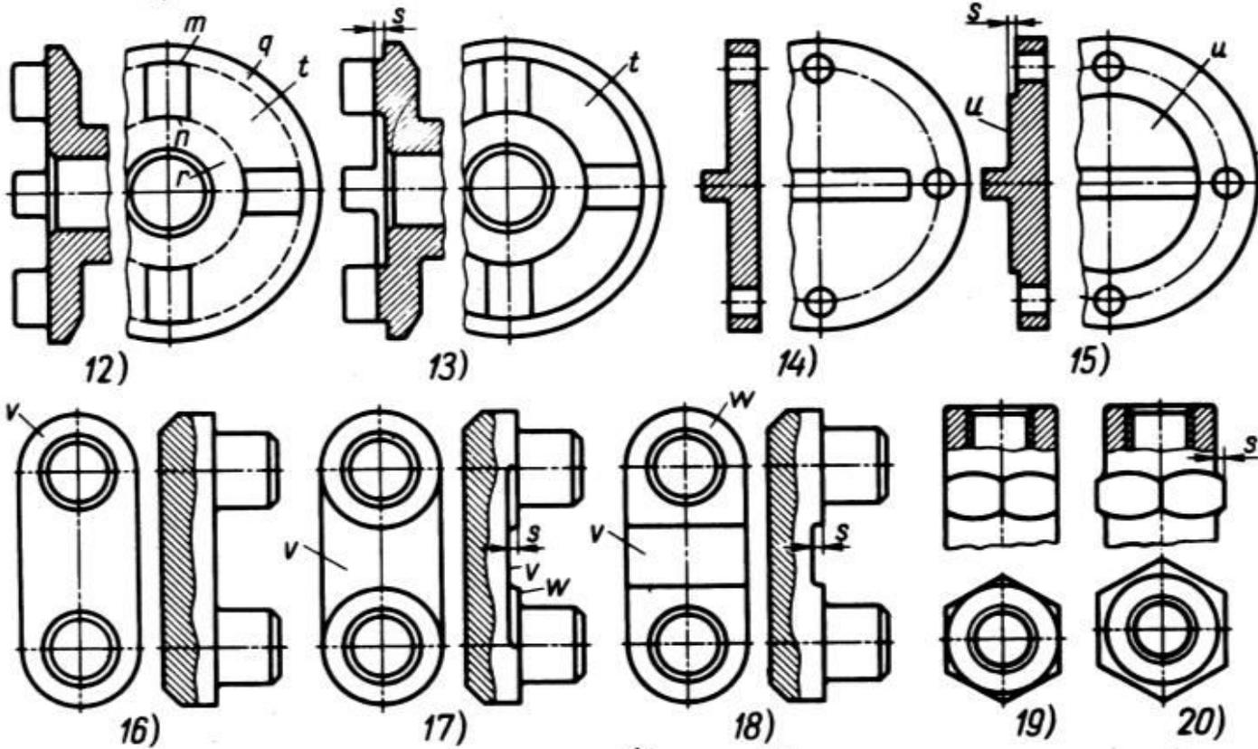
В конструкции 12 кулачковой шайбы поверхности  $m$ ,  $n$  кулачков обрабатываются точением заодно с кольцевыми участками  $q$ ,  $r$  торца диска; участки  $t$  фрезеруют. Добиться совпадения этих поверхностей невозможно. В правильной конструкции 13 фрезеруемая поверхность  $t$  расположена выше смежных поверхностей торца диска на величину  $s$ .
