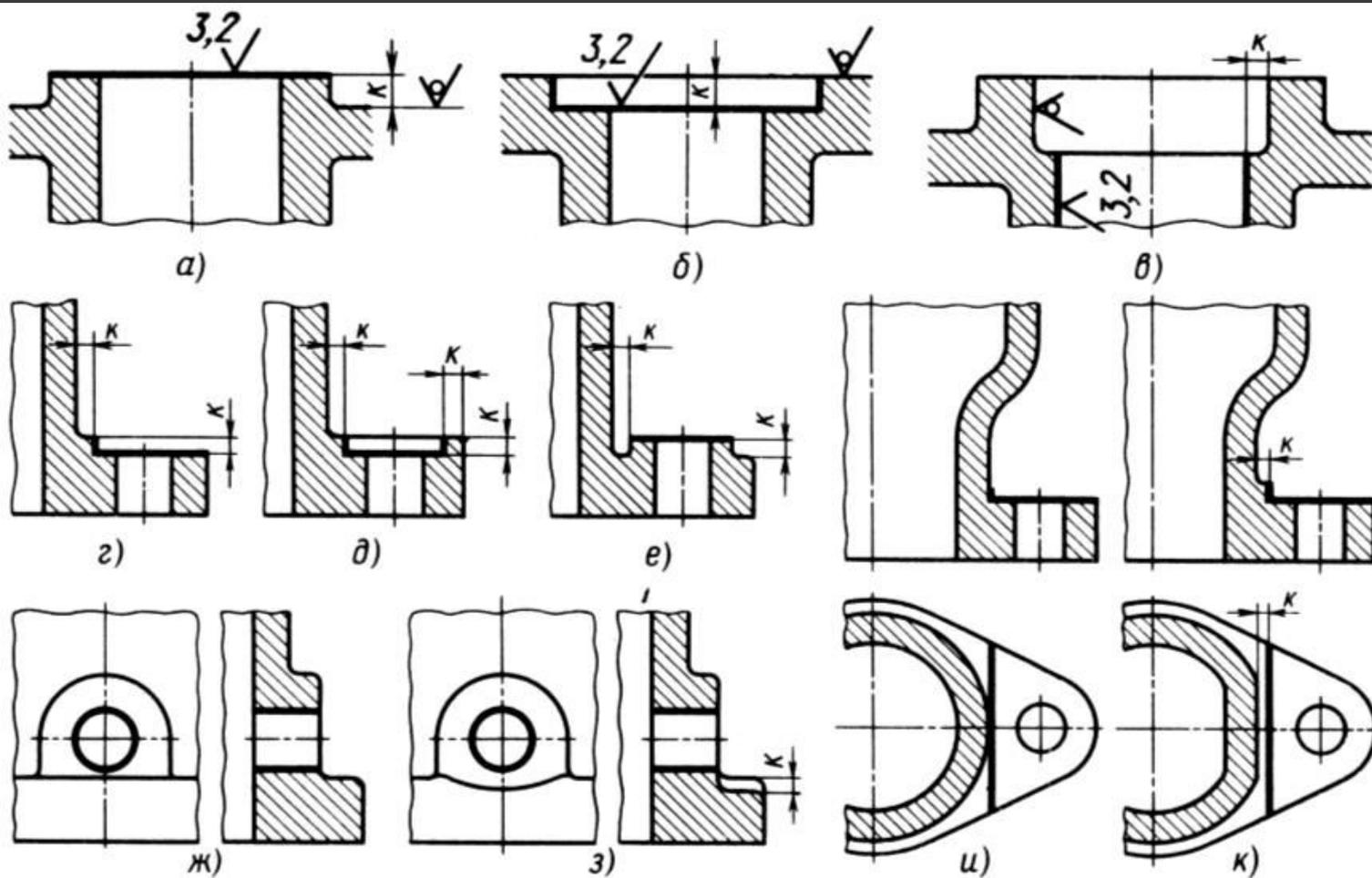
А, б, в – обрабатываемые поверхности смежные
