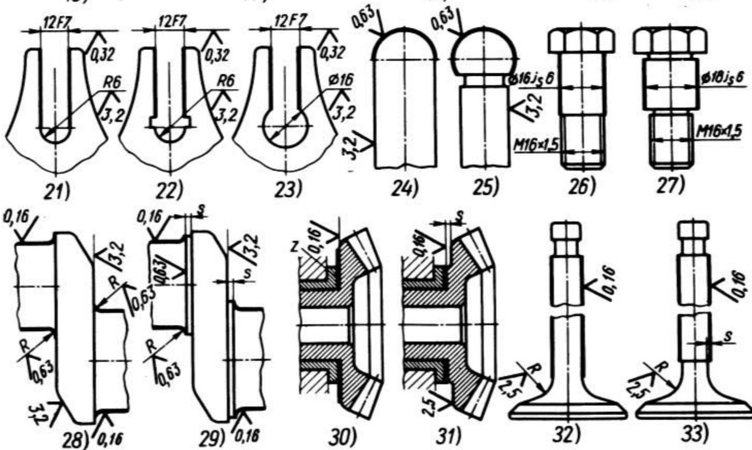
В конструкции 21 получить сопряжение шлифовальных рабочих граней паза с основанием паза, выполняемым сверлением, невозможно. Необходимо разделить поверхности точной и грубой обработки (вид 22) или выполнить основание паза диаметром, большим ширины паза (вид 23), для выхода шлифовального круга.
