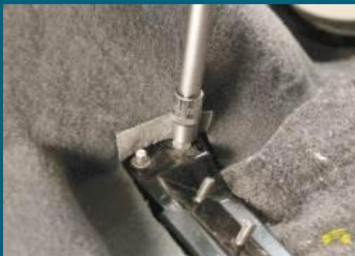
**9. Отверните шесть гаек крепления поперечины спинки заднего сиденья, снимите шайбы и поперечину.**
