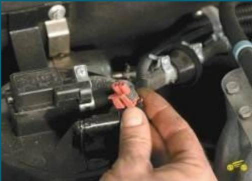
1. Для замены клапана продувки адсорбера отсоедините колодку жгута проводов от клапана.
