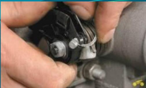
**7. Отсоедините от сектора дроссельного узла трос привода дроссельной заслонки.**
