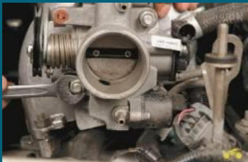
**9. Отверните две гайки крепления дроссельного узла.**
