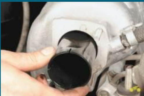
12. Извлеките из ресивера для осмотра пластмассовый диффузор, организующий воздушный поток и удалите с диффузора и из ресивера масло и прочие загрязнения.
