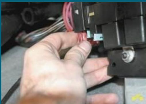
2. Извлеките предохранитель электробензонасоса.
