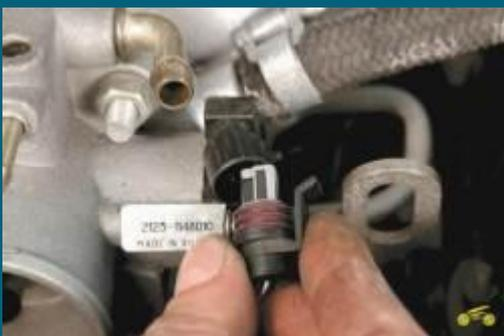
**8. Отсоедините колодки жгутов проводов от датчика положения дроссельной заслонки и регулятора холостого хода.**
