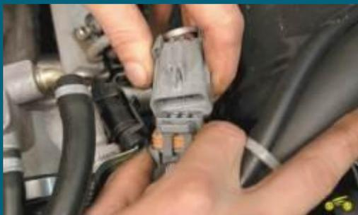
3. Разъедините соединительную колодку жгута проводов рампы и моторного жгута.
