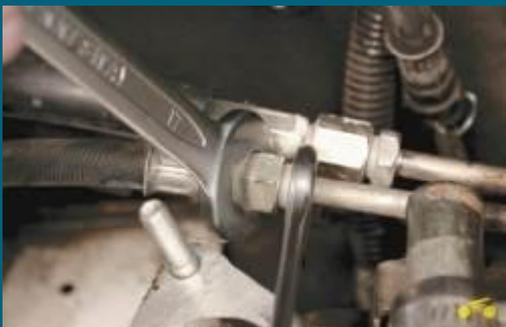
**6. Для снятия рампы с двигателя отсоедините от ее трубопроводов топливные шланги.**
