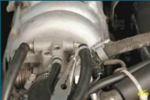
2. Ослабьте хомуты крепления к патрубкам дроссельного узла шлангов подвода охлаждающей жидкости, выньте шплинт и снимите хомуты.
