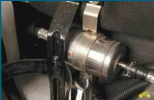
1. Снизьте давление в системе питания и ослабьте стяжной болт кронштейна крепления фильтра.
