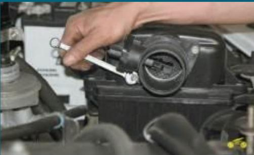
**5. При необходимости замены фильтра снимите с него датчик массового расхода воздуха, вывернув два болта крепления.**
