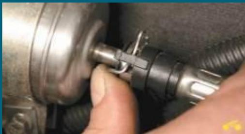
2. Отожмите пружинный фиксатор
