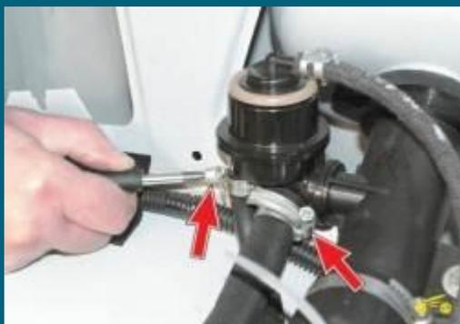
**7. Для снятия гравитационного клапана снимите правую боковую обивку багажника (см. «Замена топливного бака»), ослабьте хомуты крепления шлангов, снимите шланги с патрубков клапана и извлеките клапан из отверстия наливной трубы.**
