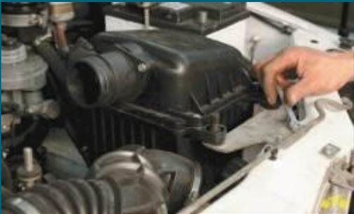
2. Ослабьте хомут крепления и отсоедините от датчика массового расхода воздуха левую часть воздухоподводящего патрубка и отведите ее в сторону.
