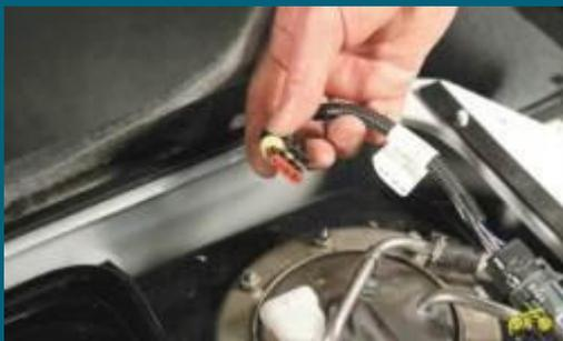
**15. Отсоедините от топливного насоса провода и шланги.**
