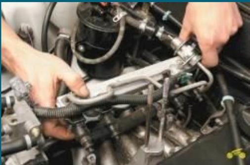
**5. Аккуратно сдвинув топливную рампу вдоль оси форсунок так, чтобы все форсунки вышли из отверстий во впускной трубе двигателя, отсоедините рампу в сборе с форсунками от впускной трубы.**
