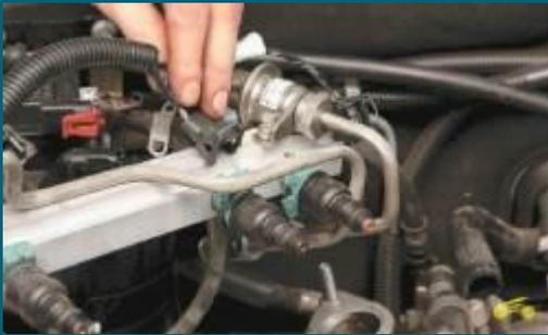
2. Нажав на пружинный фиксатор, отсоедините колодку с проводами от заменяемой форсунки.
