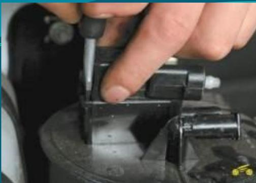
**3. Отожмите отверткой пластмассовый держатель и снимите клапан продувки.**
