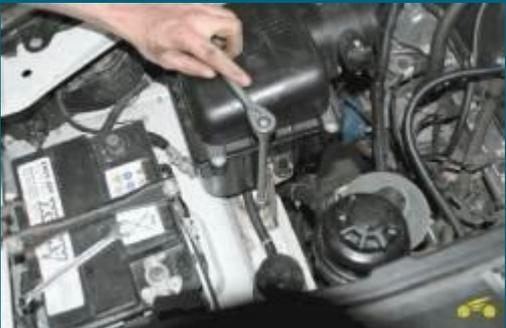
3. Выверните по два болта крепления переднего и заднего кронштейнов фильтра.
