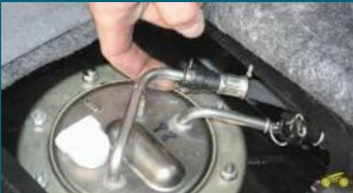
**5. Отжав пружинные фиксаторы, снимите с патрубков насоса топливные шланги и отверните восемь гаек крепления насоса.**
