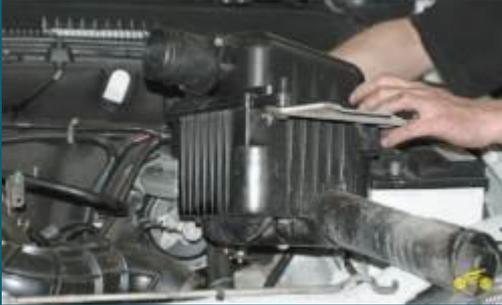
**4. Снимите фильтр вместе с кронштейнами и датчиком массового расхода воздуха.**
