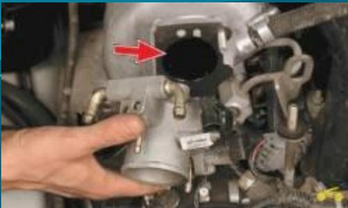
10. Снимите дроссельный узел со шпилек на ресивере. Обратите внимание, под каждой гайкой установлены по две шайбы (одна плоская и одна пружинная). Снимите с ресивера прокладку (показана стрелкой).
