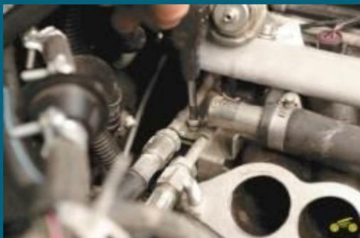
2. Выверните винт крепления фиксатора трубопроводов топливных магистралей и снимите фиксатор.
