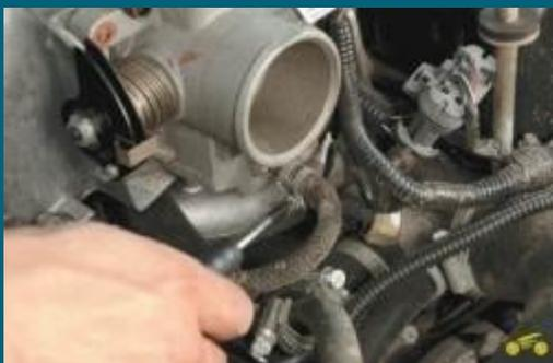
**6. Ослабьте хомут крепления и отсоедините от патрубка дроссельного узла шланг продувки адсорбера.**
