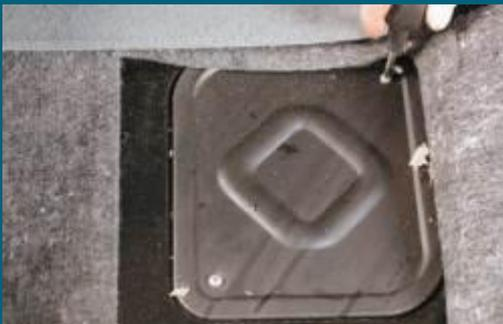
3. Выверните два винта крепления и снимите крышку люка.
