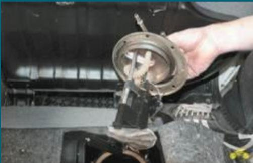
**6. Поднимите насос вверх, наклоните его, чтобы вывести из люка поплавков датчика указателя уровня топлива, и снимите насос вместе с прижимным кольцом.**
