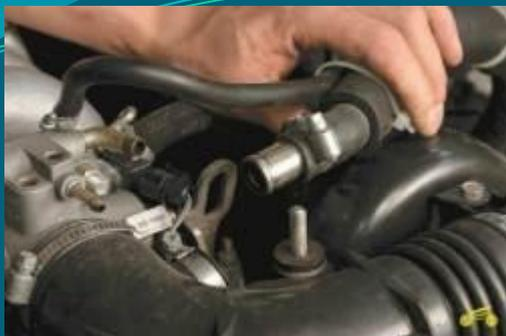
**4. Ослабьте хомут крепления и отсоедините от правой части воздухоподводящего патрубка шланг большой ветви системы вентиляции картера.**
