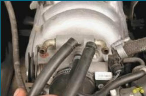
3. Отсоедините шланги подачи охлаждающей жидкости и шланг малой ветви системы вентиляции картера.
