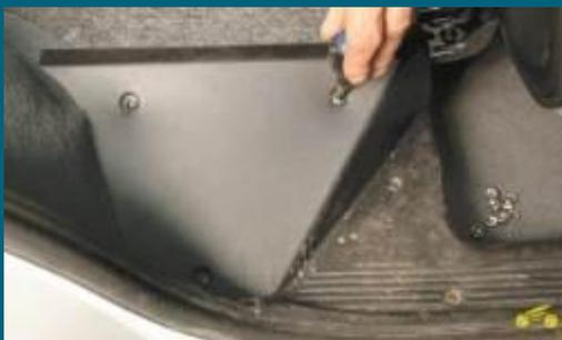
**5. Выверните винты крепления задних накладок обивки с обеих сторон и снимите накладки.**
