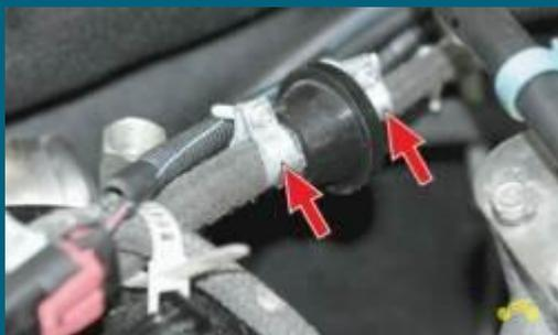
**6. Для снятия двухходового клапана ослабьте хомуты крепления шлангов и извлеките клапан из магистрали.**
