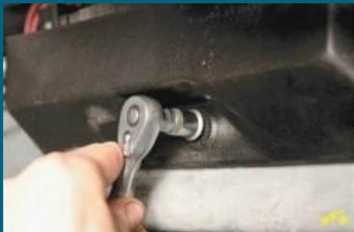
1. При первом способе внутри салона отверните гайку крышки блока управления двигателем и снимите крышку.
