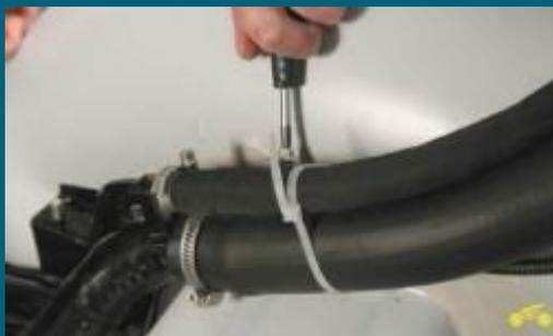
**17. Снимите шланги с патрубков топливного бака и извлеките бак.**
