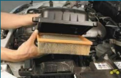
2. Приподнимите крышку и выньте из нее фильтрующий элемент.
