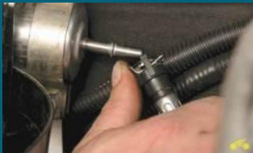
3. Снимите с патрубка фильтра наконечник топливного шланга.
