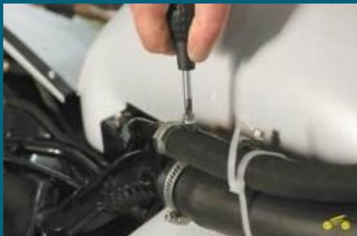
**16. Ослабьте хомуты крепления подающего и воздухоотводящего шлангов наливной трубы, шланга системы улавливания паров топлива.**
