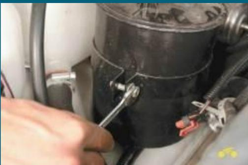
**4. Для снятия адсорбера выполните операции 1 и 2, выверните стяжной болт хомута крепления адсорбера.**
