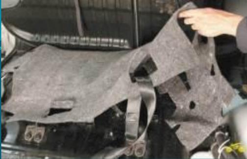
**10. Снимите шумоизоляционный коврик пола багажника.**
