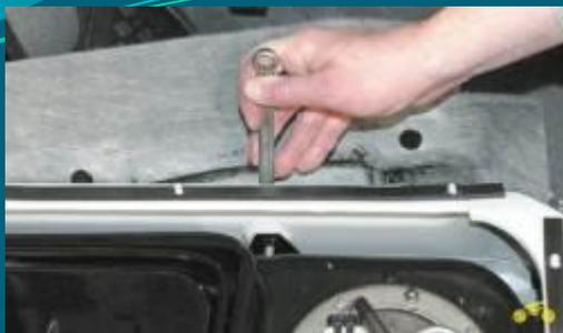
**13. Отведите в сторону коврик пола и выверните болты крепления передних опор топливного бака.**
