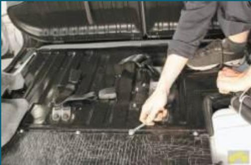
**11. Отверните гайки крепления крышки отсека топливного бака.**
