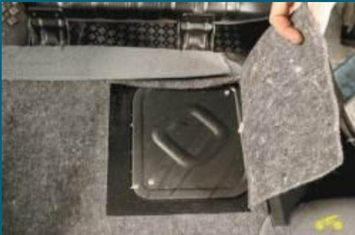
2. Отогните вырезанную часть шумоизоляции, под которой находится крышка люка над топливным баком.
