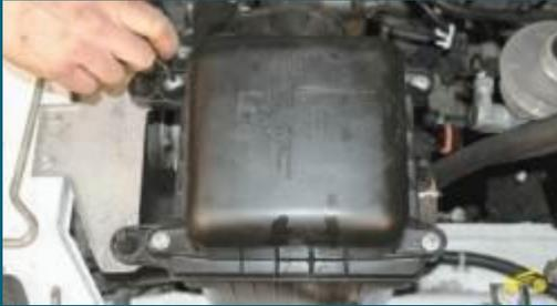
1. Выверните четыре винта крепления крышки фильтра.
