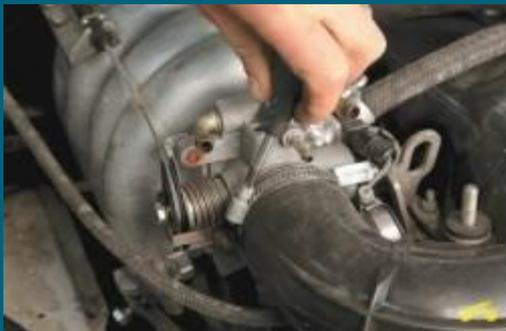
**5. Ослабьте хомуты крепления правой части воздухоподводящего патрубка к дроссельному узлу и промежуточному кронштейну и снимите ее.**
