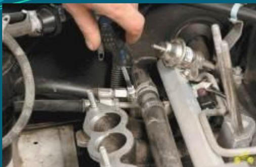
1. Ослабьте хомут крепления шланга радиатора отопителя и снимите его с патрубка головки блока цилиндров.
