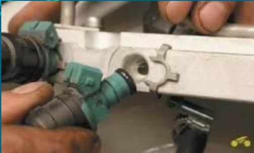
**4. Выньте форсунку из топливной рампы. Аналогичным образом выньте остальные неисправные форсунки.**
