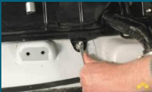
**14. Отверните гайки крепления задних опор топливного бака.**
