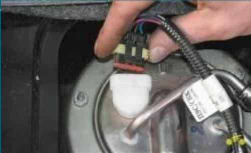
**4. Отсоедините от переходной колодки насоса колодку жгута проводов.**
