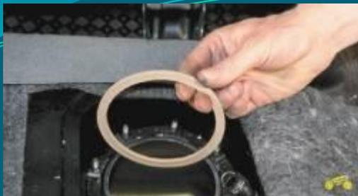
7. Если уплотнительное кольцо насоса осталось на баке, снимите его и осмотрите. Сильно обжатое, потерявшее упругость или надорванное кольцо замените.
