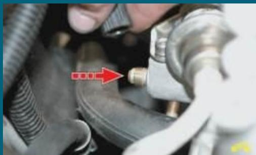
6. После этого можно разъединять топливопроводы.
