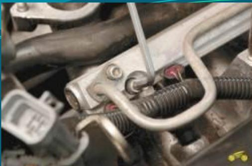
**4. Выверните два винта крепления рампы к впускной трубе.**
