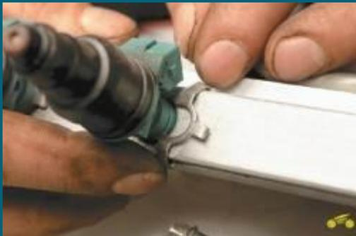
3. Сдвиньте фиксатор форсунки в сторону.
