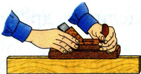
**8. Стругать вторую кромку в размер 50 мм**
