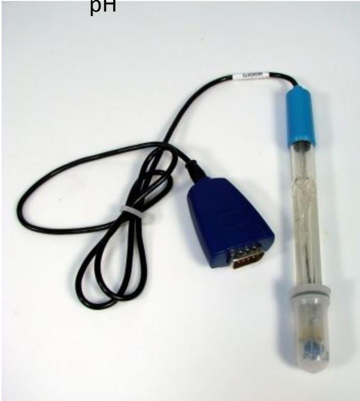
Предназначен для измерения водородного показателя (кислотности) среды. Используется в темах "Кислоты и основания", "Гидролиз", "Кислотно-основные реакции".
