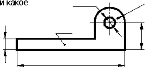
6.2. Выбрать из перечисленных назначений линий (а, б, в, г, д) соответствующие и обозначить их на полках линий-выносок.
