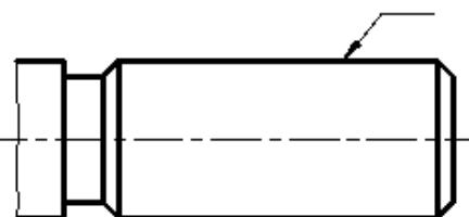
8.8. Нанести размеры поверхностей А и Б. Поверхность А - цилиндр диаметра 12 мм, в сечении поверхности Б - квадрат со стороной 8 мм.
