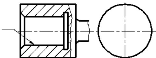
7.8. Нанести размеры отверстий, применив условность для обозначения повторяющихся одинаковых элементов. (Диаметр больших отверстий - 7 мм, меньших - 3 мм.)
