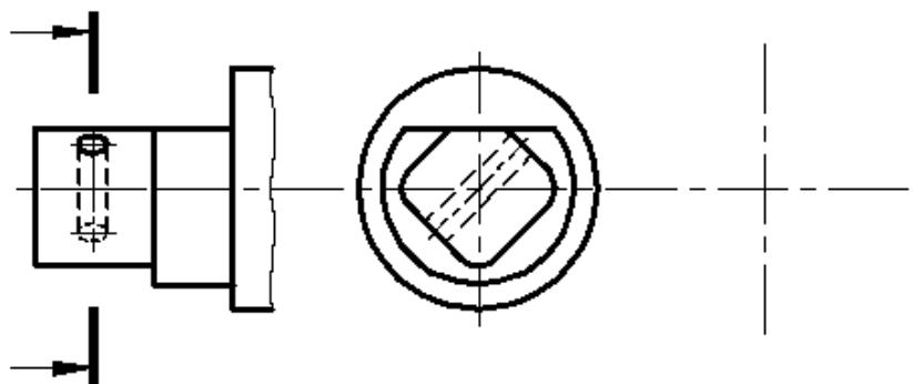
8.7. Дочертить условное изображение резьбы на поверхности А и обозначить. Резьба прямоугольная, наружный диаметр 20 мм, внутренний диаметр 16 мм, шаг 4 мм, ширина профиля резьбы 2 мм.
