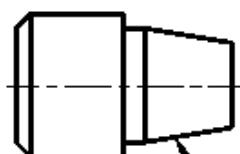
10.8. Нанести размеры поверхностей А и Б. Поверхность А - цилиндр диаметра 16 мм, Б - фаска под углом 45° (размер фаски 2 мм).
