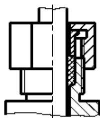
4.10. Дочертить линии резьбы в соединении, нанести штриховку на разрезе. Достроить вид сверху.
