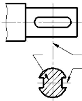
9.3. Применить графическое обозначение материала при штриховке в сечении детали из фенопласта.
