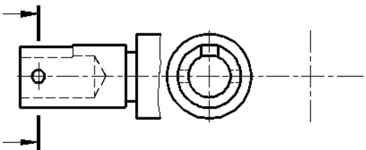
9.7. Дочертить условное изображение резьбы на внутренней поверхности и обозначить. Резьба трубная, размер резьбы в дюймах - 1. Дочертить вид слева.
