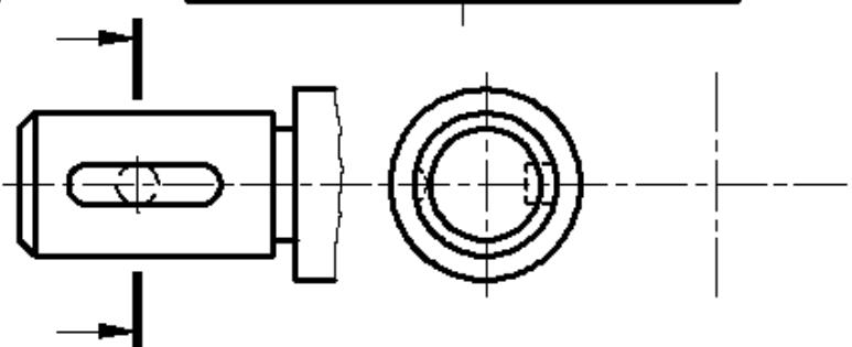
10.7. Дочертить условное изображение резьбы на поверхности А и обозначить. Резьба трубная коническая, размер резьбы в дюймах -  $1\frac{1}{2}$ .
