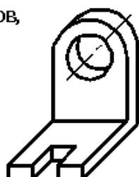
1.5. Вид спереди заменить указанным разрезом и обозначить.
