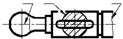
4.3. Применить графическое обозначение материала при штриховке в сечении детали из древесины.
