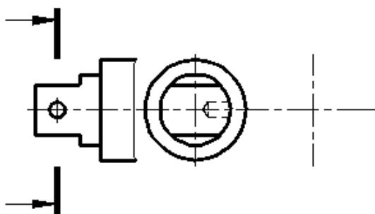
7.7. Дочертить условное изображение резьбы на поверхности A и обозначить. Резьба метрическая, наружный диаметр 16 мм, шаг мелкий 1,5 мм. Дочертить вид слева.
