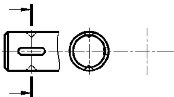
3.7. Дочертить условное изображение резьбы на поверхности А детали и обозначить. Резьба метрическая, наружный диаметр 24 мм, шаг мелкий 1,5 мм. Начертить вид слева.
