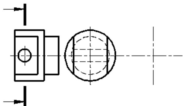
4.7. Дочертить условное изображение резьбы на поверхности А и обозначить. Резьба метрическая, наружный диаметр 10 мм, шаг мелкий 1 мм. Начертить вид слева.
