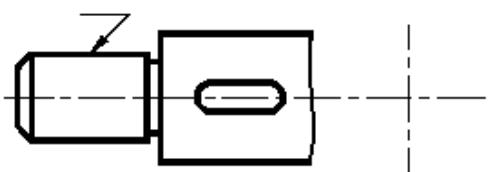
2.8. Нанести размеры фасок, применив условности для обозначения одинаковых элементов (все фаски  $1 \times 45^\circ$ ).
