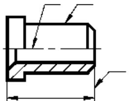
3.3. Применить графическое обозначение материала при штриховке в сечении детали из фарфора.
