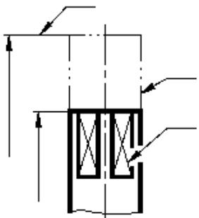
10.3. Применить графическое обозначение материала при штриховке в сечении детали из пресс-материала.
