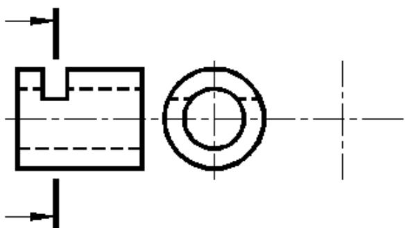
2.7. Дочертить условное изображение резьбы на поверхности А и обозначить. Резьба метрическая, наружный диаметр 12 мм, шаг крупный 1,75 мм. Начертить вид слева.
