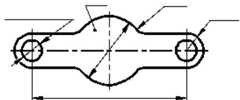
4.2. Выбрать из перечисленных назначений линий (а, б, в, г, д) соответствующие и обозначить их на полках линий-выносок.
