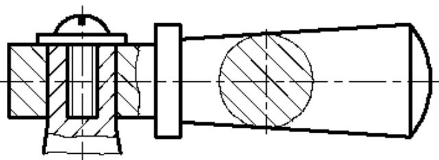
9.10. Дочертить линии резьбы в соединении, настриховку на разрезе. Достроить вид сверху.
