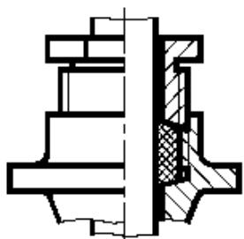
2.10. Дочертить линии резьбы в соединении, нанести штриховку на разрезе. Достроить вид сверху.
