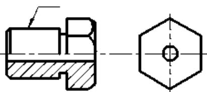
5.7. Дочертить условное изображение резьбы на поверхности A и обозначить. Резьба метрическая, наружный диаметр 14 мм, шаг мелкий 1,5 мм. Дочертить вид слева.
