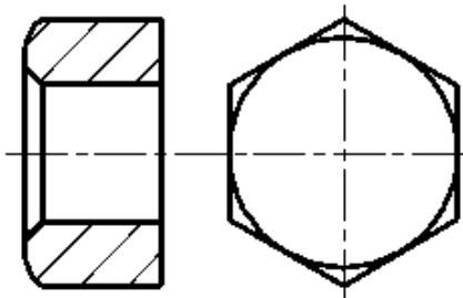
1.8. Нанести размеры фасок с углами А ( $45^\circ$ ) и Б ( $30^\circ$ ). (Величина фасок 2 мм).
