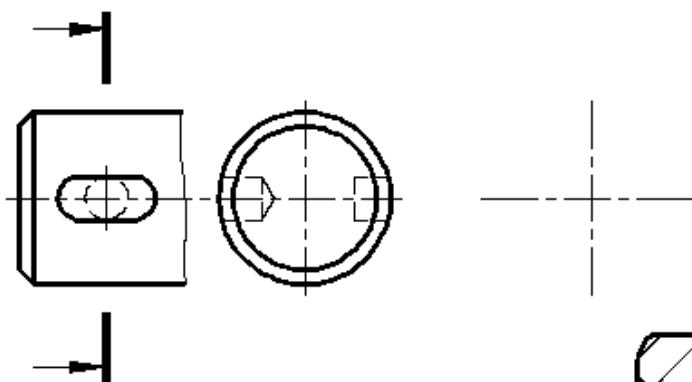
1.7. Дочертить условное изображение резьбы на внутренней поверхности детали. Резьба метрическая, наружный диаметр 20 мм, шаг мелкий 1,5 мм. Обозначить резьбу.
