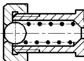
7.10. Дочертить линии резьбы в соединении, нанести штриховку на разрезе. Достроить вид сверху.
