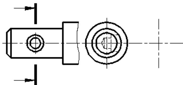
6.7. Дочертить условное изображение резьбы на поверхности А и обозначить. Резьба метрическая, наружный диаметр 6 мм, шаг крупный 1 мм. Дочертить вид слева.
