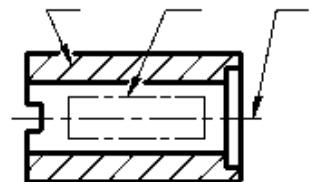
7.3. Применить графическое обозначение материала при штриховке в сечении детали из металла
