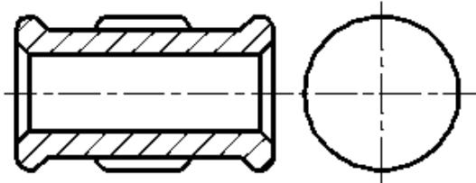
9.8. Нанести размеры фасок, применив условность для обозначения одинаковых элементов (размер фаски 1,6 мм, угол - 45°).
