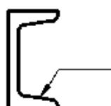
5.8. На полке линии-выноски обозначить уклон поверхности (уклон 1:10).
