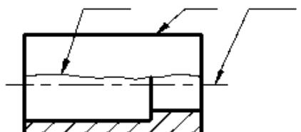
5.3. Применить графическое обозначение материала при штриховке в сечении детали из металла.
