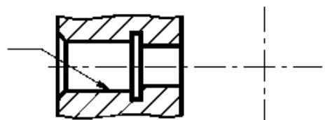
3.8. На полке линии-выноски обозначить конусность поверхности (конусность 1:7).
