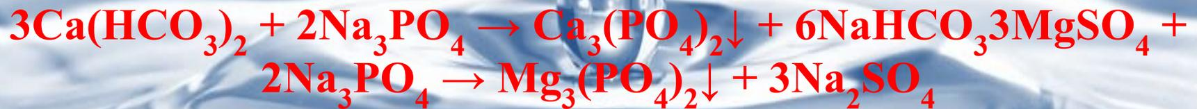
Ортофосфаты кальция и магния очень плохо растворимы в воде, поэтому легко отделяются механическим фильтрованием. Этот метод оправдан при относительно больших расходах воды, поскольку связан с решением ряда специфических проблем: фильтрации осадка, точной дозировки реагента.
