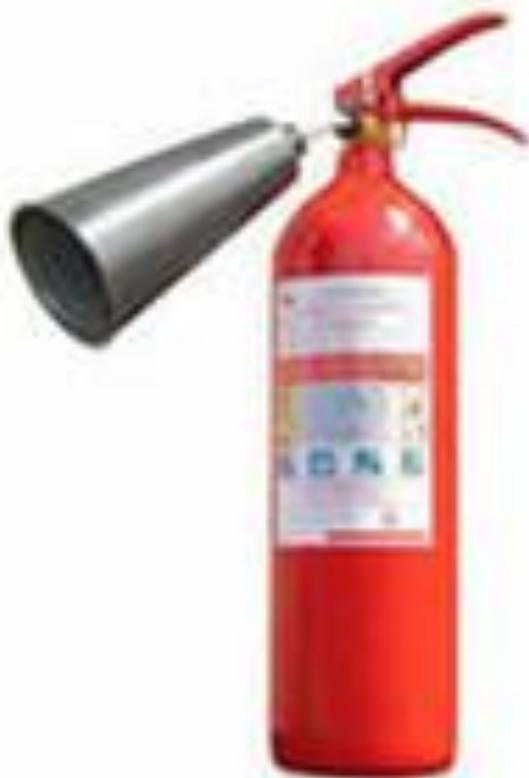
○ Применяется при тушении малых очагов возгорания всех типов пламени. Радиус действия 4 м, при срабатывании температура рабочего вещества понижается до  $-70^{\circ}\text{C}$ , появляются снежные хлопья, охлаждающие зону горения.
