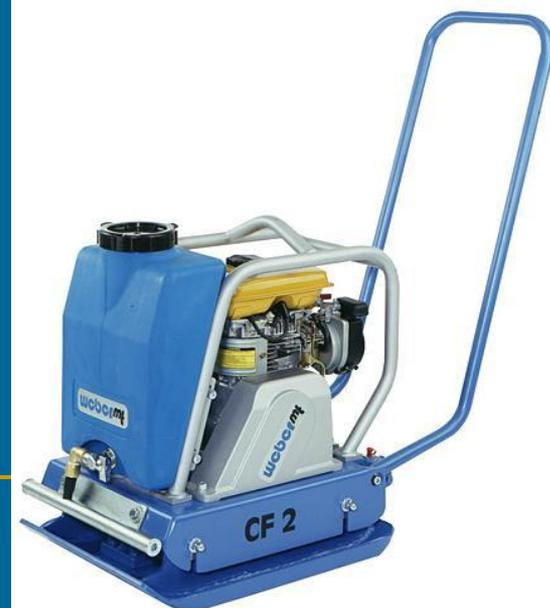
**Поверхностное уплотнение тяжелыми трамбовками применяется для сыпучих, а также лёссовых грунтов. Наибольший эффект уплотнения грунтов достигается при наличии в основании оптимальной влажности**
