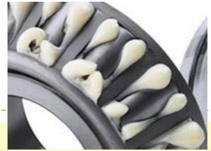
В качестве загустителя используются соли высших карбоновых кислот (мыла). Наиболее распространены кальциевые, литиевые, бариевые и натриевые смазки.
