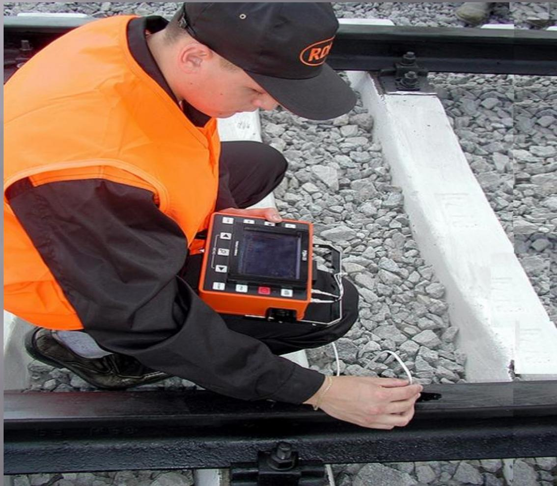
Различным включениям в структуре металла свойственна определенная величина акустического сопротивления. Зачастую в этих включениях содержится воздух, акустическое сопротивление которого намного больше, чем у металла. А потому данные участки (в сущности, дефектные) практически недоступны для ультразвука. **Ультразвуковой контроль** может быть направлен на выявление дефектов: несплошностей, нарушений однородности, трещин, посторонних включений и т.д.
