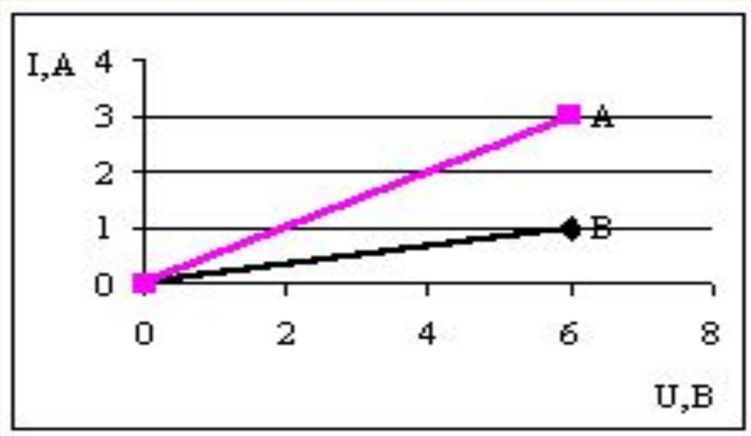
На рисунке изображены графики зависимости силы тока от напряжения для двух проводников А и В. Какой из этих проводников обладает большим сопротивлением?
