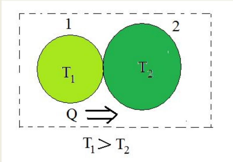
При соприкосновении 1-е тело передает 2-му на элементарном участке  $\delta Q$  процесса теплоту .
