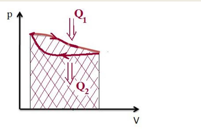
Для выполнения последнего условия р.т. должно в ходе расширения принимать тепло (обозначим его  $Q_1$ ), а в ходе сжатия отдавать тепло ( $Q_2$ ) холодильнику.
