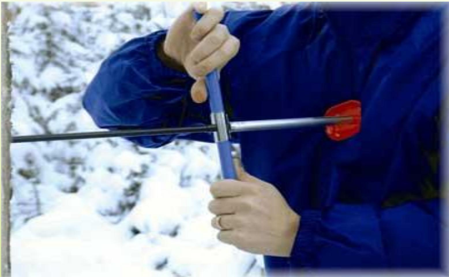
Для того чтобы при таких подсчётах не губить понапрасну дерево, лесные специалисты придумали инструмент – бурав (стальную трубку с полой винтовой резьбой по внешней поверхности).
