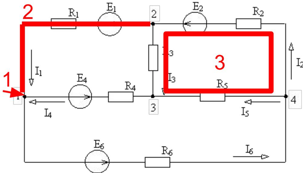
Основными элементами топологии электрических цепей являются узел (1), ветвь (2) и контур (3).
