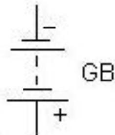
Батарея из гальванических элементов
