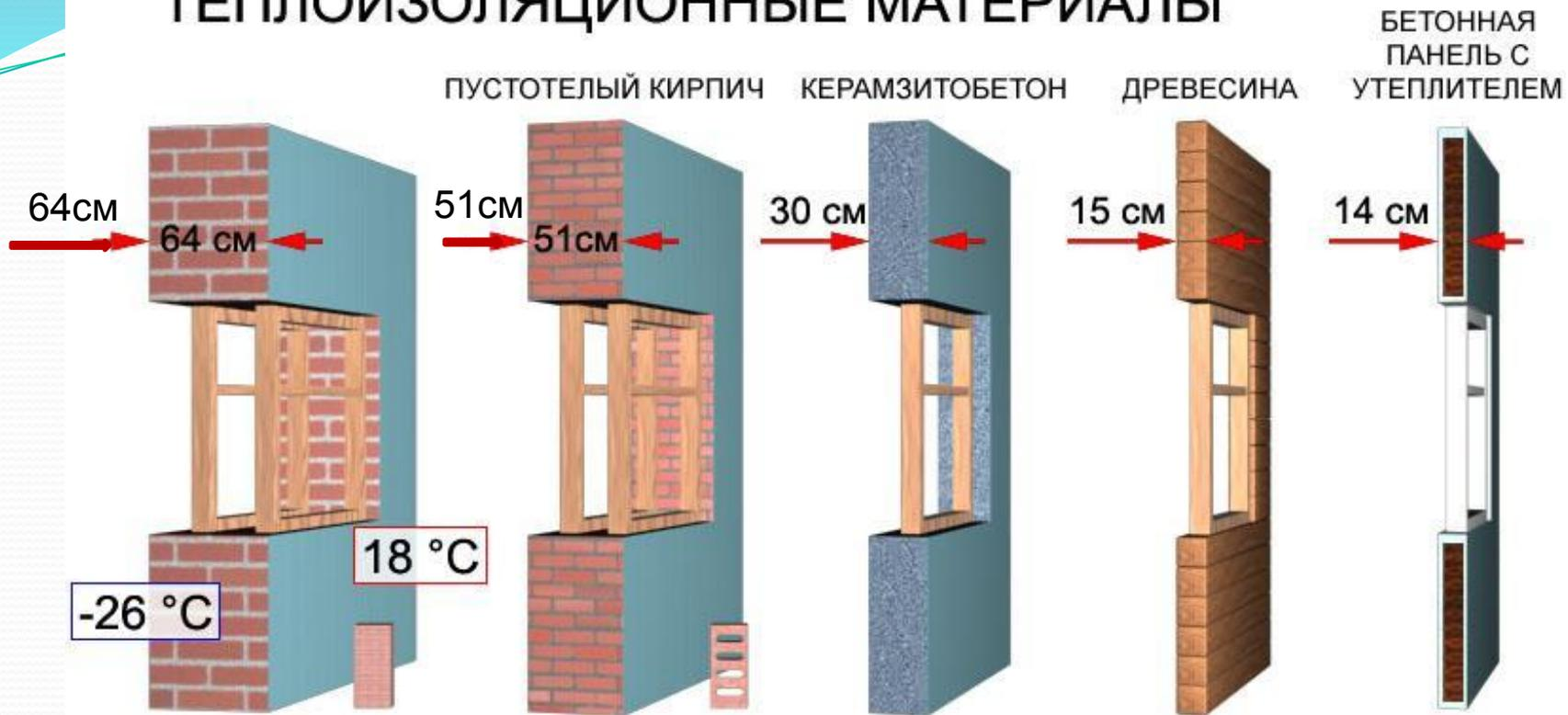
ШКАЛА ТОЛЩИНЫ МАТЕРИАЛОВ ПРИ ОДИНАКОВОЙ ТЕПЛОПРОВОДНОСТИ
