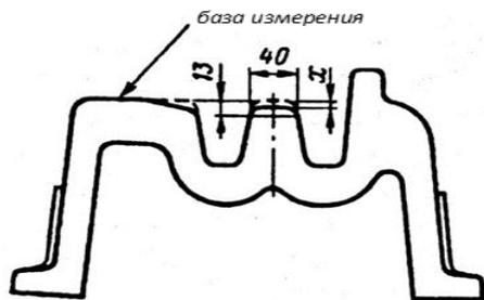
Измерение вертикального износа сердечника цельнолитой тупой крестовины (мм)
