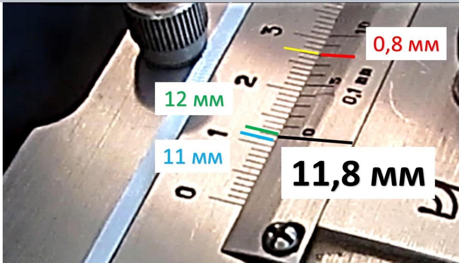
Количество миллиметров определяем по «0», а **десятые** - по **линии нониуса**, которая полностью совпала с делением шкалы на линейке
