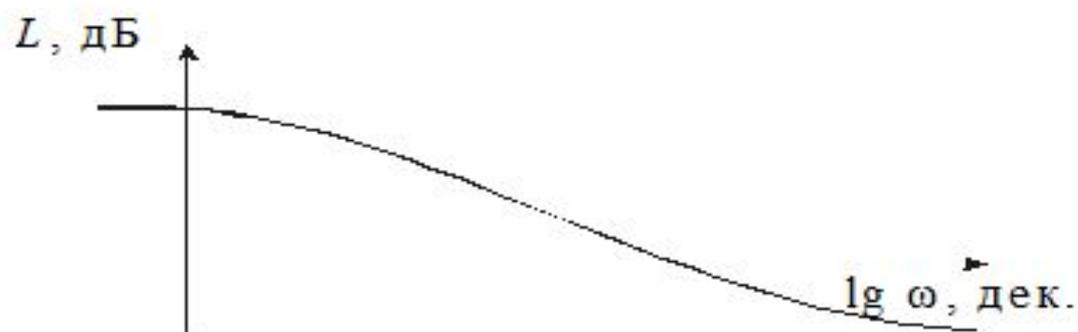
Рисунок 2.9 – Пример логарифмической амплитудной частотной характеристики
