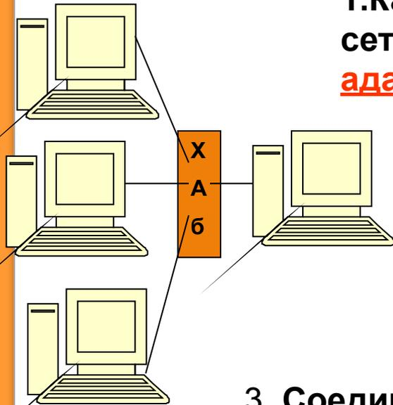
2. Хаб(узел)- выполняет функции коммутатора, рабочие станции подсоединяются по индивидуальным каналам связи к одному хабу, который соединяется одним каналом с остальной сетью.
