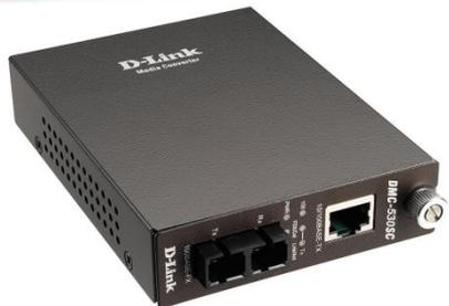
**Медиаконвертер DMC-530SC** преобразует сигнал из стандарта 100BASE-TX Fast Ethernet на витой паре в сигнал стандарта 100BASE-FX Fast Ethernet по одномодовому оптическому кабелю (1 порт RJ-45 для витой пары и 1 оптический порт для SC-коннектора). Максимальная длина оптического кабеля – 30 км.
