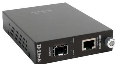
**Медиаконвертер DMC-805G** оснащен 1 портом RJ-45 для витой пары и 1 SFP-портом (mini-GBIC) и осуществляет преобразование интерфейсов «витая пара – одномодовый / многомодовый оптический кабель» для сетей Gigabit Ethernet 1000BASE-T и 1000BASE-SX/LX/ZX (mini-GBIC).
