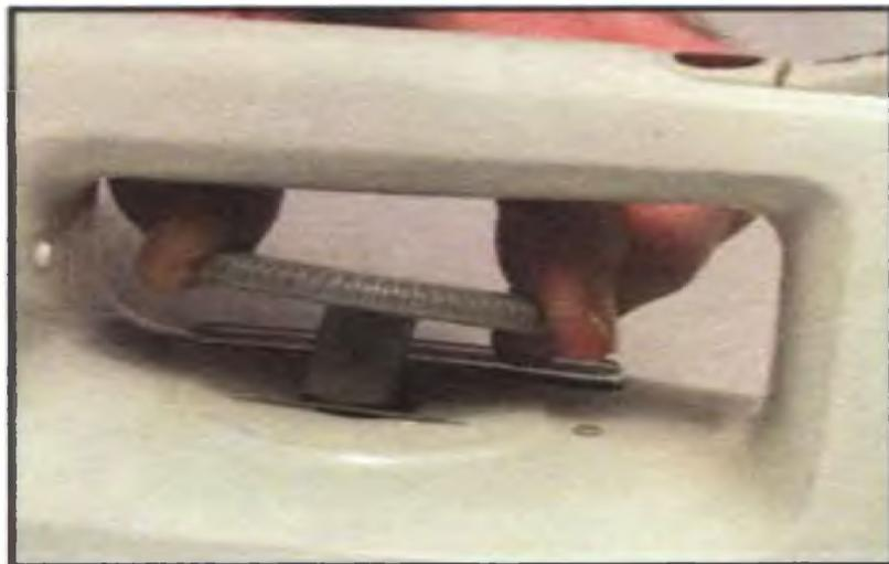
Новая ручка зафиксируется автоматически
