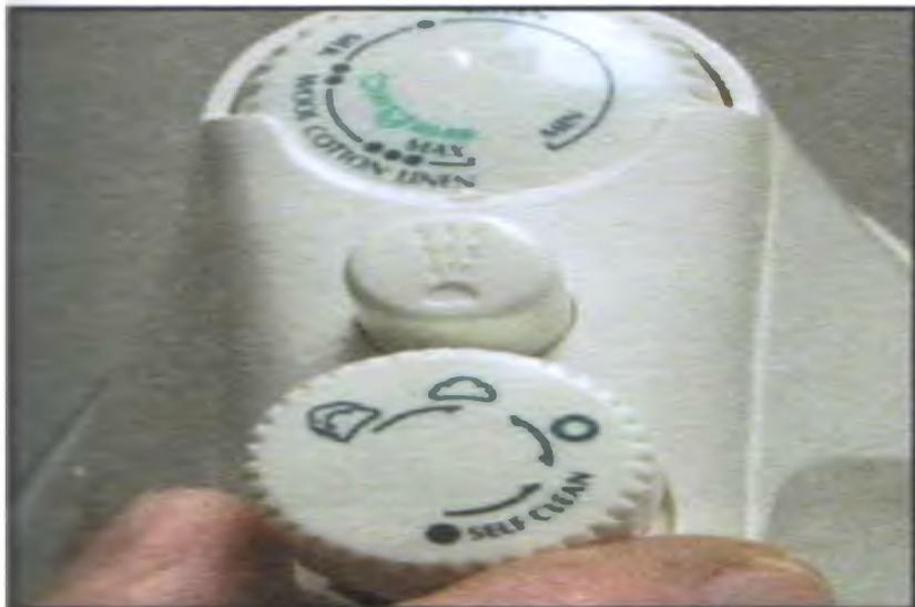
**1 Приподнимите регулятор, чтобы пар прочистил отверстия**
