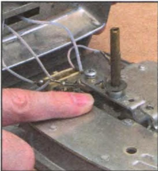
Осмотрите и проверьте тестером терморегулятор
