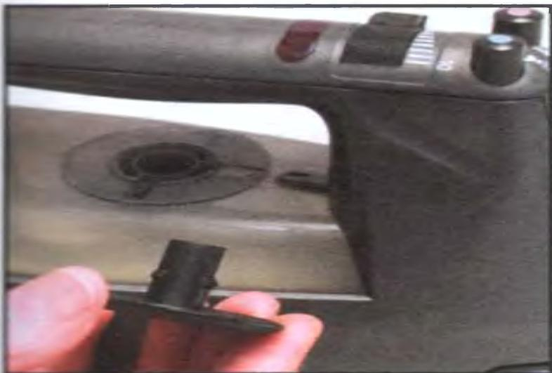
**1** Некоторые ручки терморегулятора имеют встроенные зажимы
