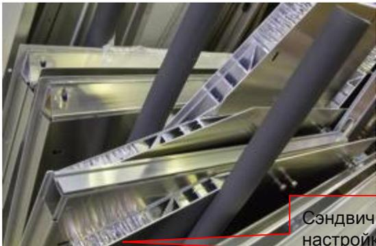
Сэндвич-панели – уплотнение, дополнительная термо- и шумоизоляция
