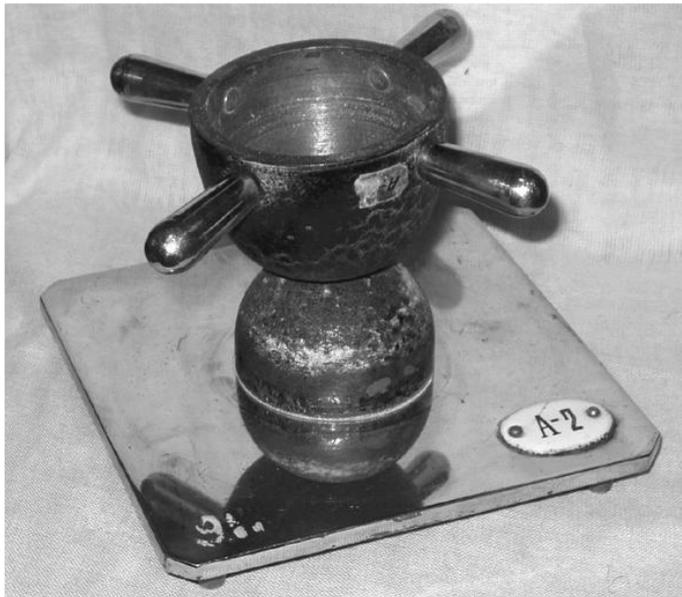
Пятиподвижная высшая кинематическая пара. Допускает пять относительных движений звеньев: три вращательных и два поступательных. Контакт звеньев происходит в точке.
