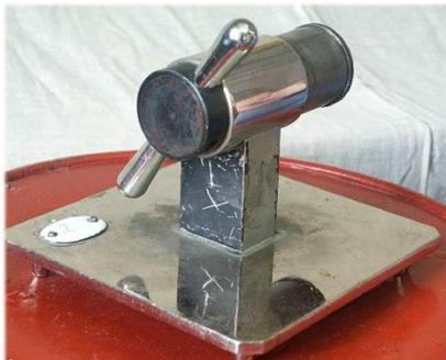
Двухподвижная цилиндрическая кинематическая пара. Допускает одно вращательное и одно поступательное относительные движения звеньев. Пара низшая, так как контакт звеньев происходит по поверхности (цилиндру).
