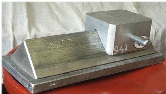
Одноподвижная поступательная кинематическая пара. Допускает только одно поступательное относительное движение звеньев. Пара низшая, так как контакт звеньев происходит по поверхности (плоскостям). В модели используется призматическая форма контактирующих поверхностей. Замыкание пары силовое (с помощью сил веса).
