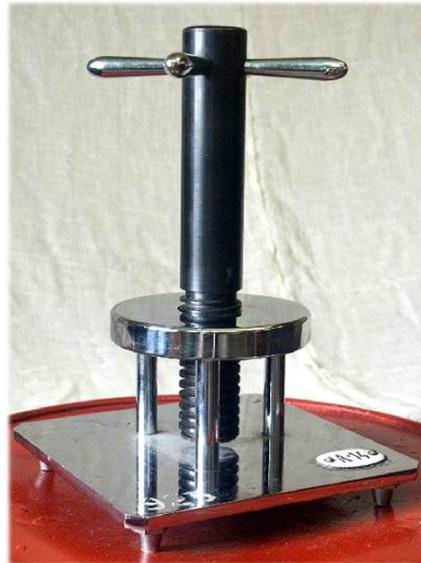
Одноподвижная винтовая кинематическая пара. Относительное движение звеньев в паре – винтовое, в котором вращательное движение функционально связано с поступательным (при повороте звена на оборот оно перемещается в осевом направлении на шаг винта). Пара низшая, так как контакт звеньев происходит по поверхности (поверхность винта конгруэнтна контактной поверхности гайки).
