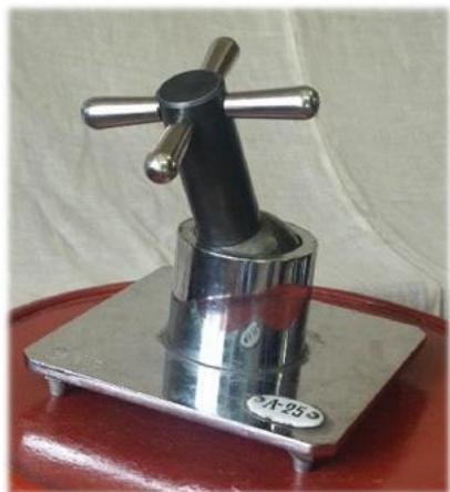
Трехподвижная сферическая кинематическая пара. Допускает три вращательных относительных движения звеньев. Пара низшая, так как контакт звеньев происходит по поверхности (сфере).
