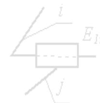
Одноподвижная поступательная кинематическая пара. Допускает только одно поступательное относительное движение звеньев. Пара низшая, так как контакт звеньев происходит по поверхности (плоскостям). Используемая в модели форма контактирующих поверхностей называется «ласточкин хвост». Замыкание пары геометрическое (за счет формы контактирующих поверхностей).
