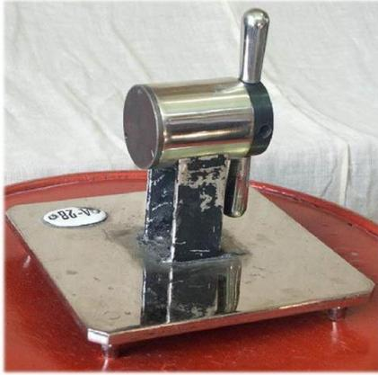
Одноподвижная вращательная кинематическая пара. Допускает только одно вращательное относительное движение звеньев. Пара низшая, так как контакт звеньев происходит по поверхности (цилиндру).
