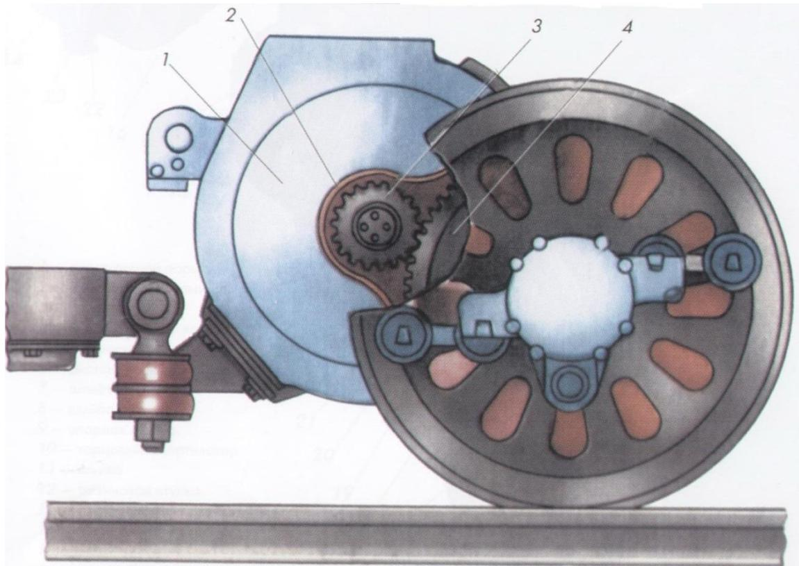
1) Тяговый электродвигатель, 2) кожух зубчатой передачи, 3) Шестерня, 4) Зубчатое колесо.
