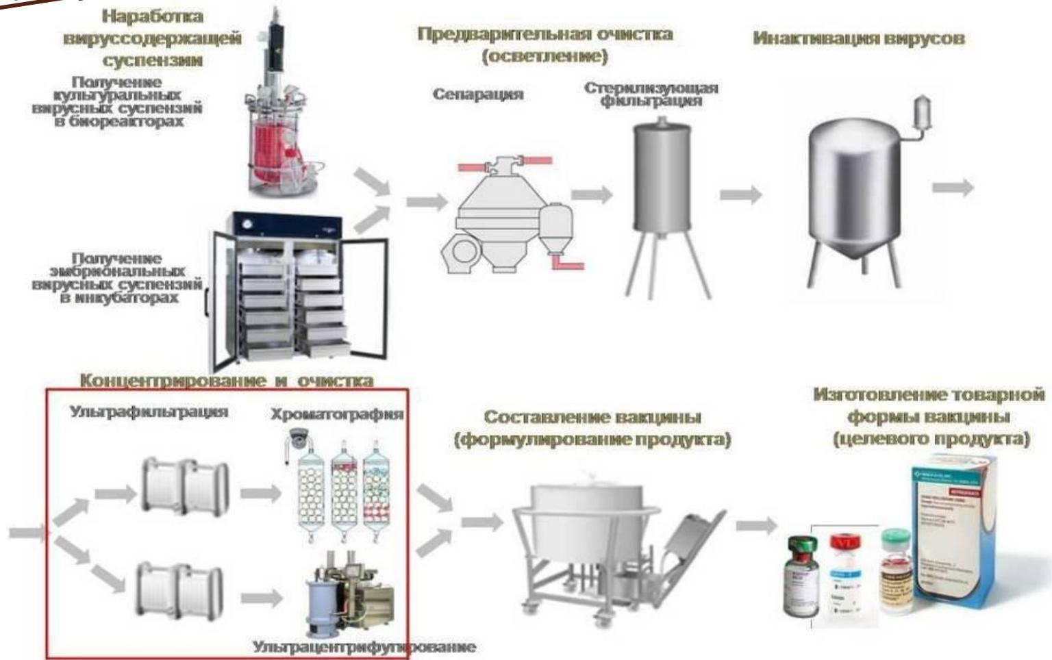
Типичная схема получения биологических препаратов медицинского назначения показана на рисунке. Она включает этапы наработки вирусной суспензии, ее осветления, инактивации вирусов, концентрирования, очистки и выделение антигена, составления вакцины (формулирование продукта), изготовление товарной формы вакцины (целевого продукта).
