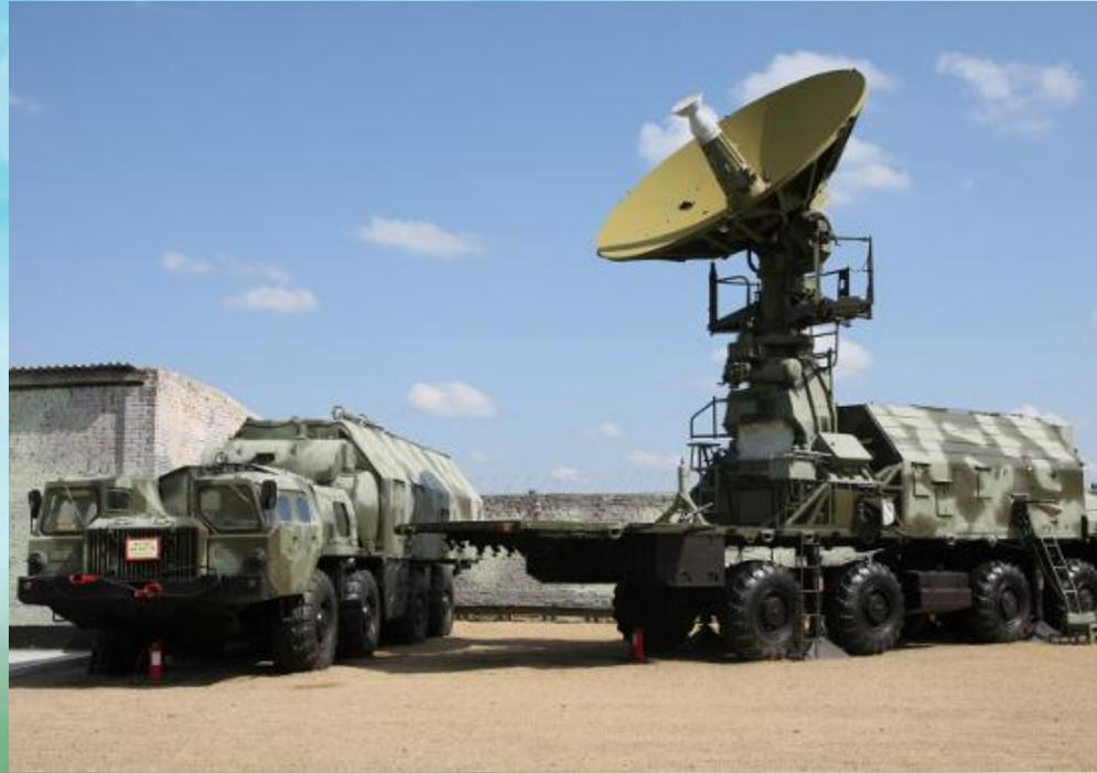
Предназначена для управления космическими аппаратами ближнего и среднего космоса, находящихся на эллиптических, круговых и стационарных орбитах. Выпускается в подвижном варианте, расположенном на автомобильном шасси.
