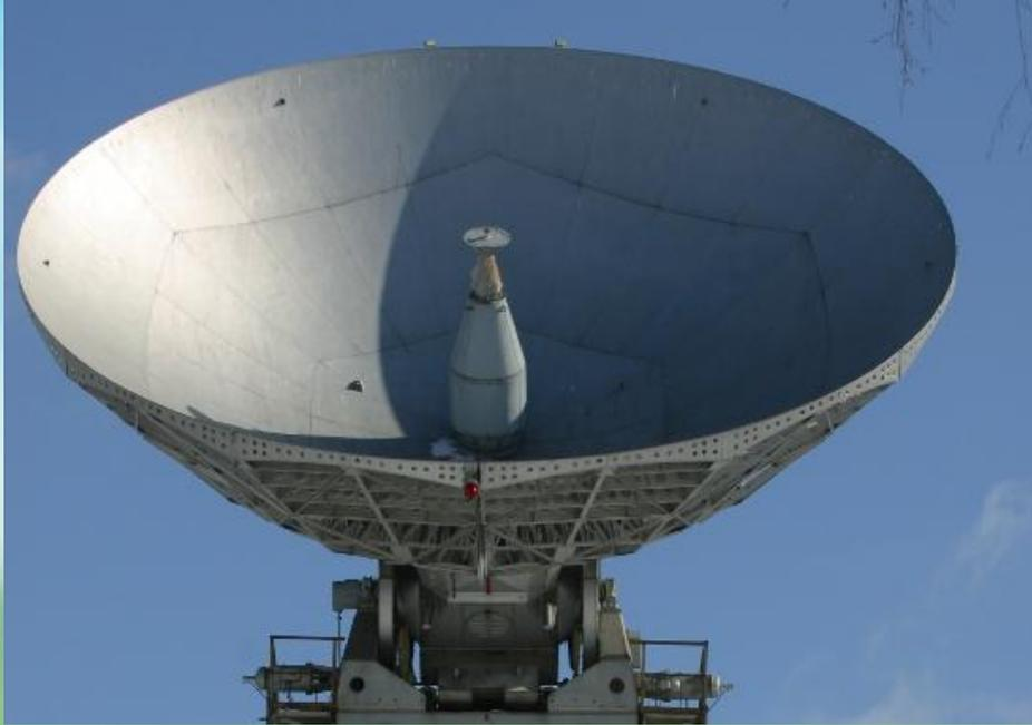
Предназначена для управления космическими аппаратами ближнего и среднего космоса, находящихся на эллиптических, круговых и стационарных орбитах. Выпускается в стационарном варианте, расположенном в техническом здании.
