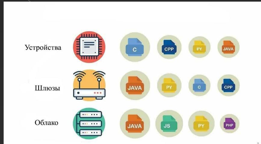
Для контроллеров и прочего железа с низкой вычислительной мощностью и с малым ОЗУ, «C» является предпочтительным языком программирования, а для шлюзов и облачных платформ «Java» – лучший выбор.
