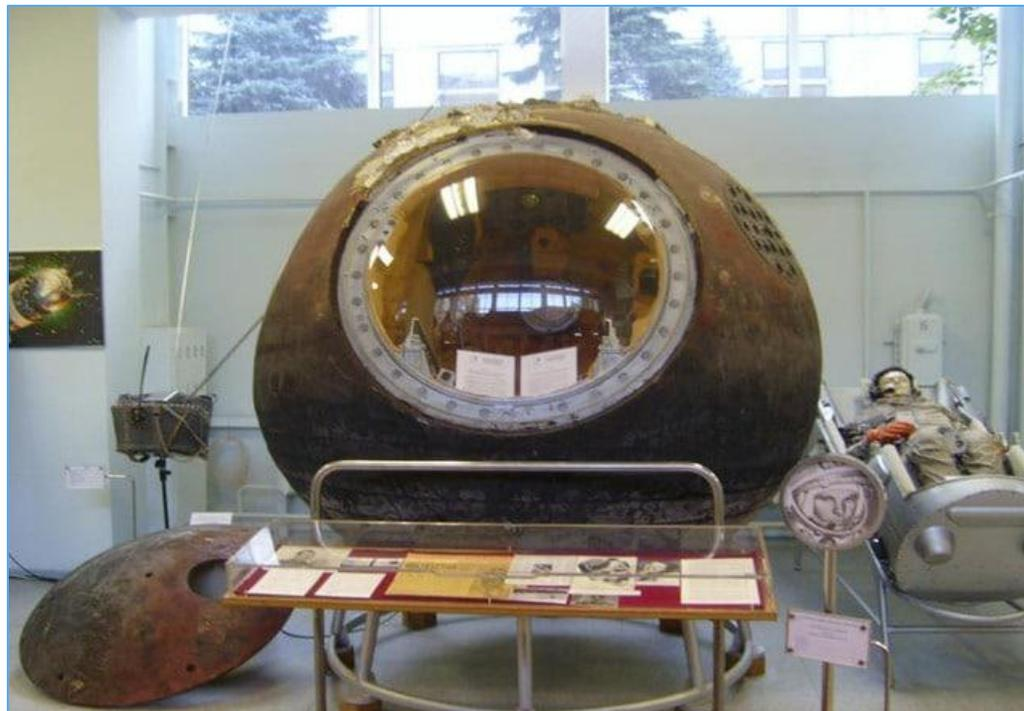
**Спускаемый аппарат космического корабля «Восток»**
