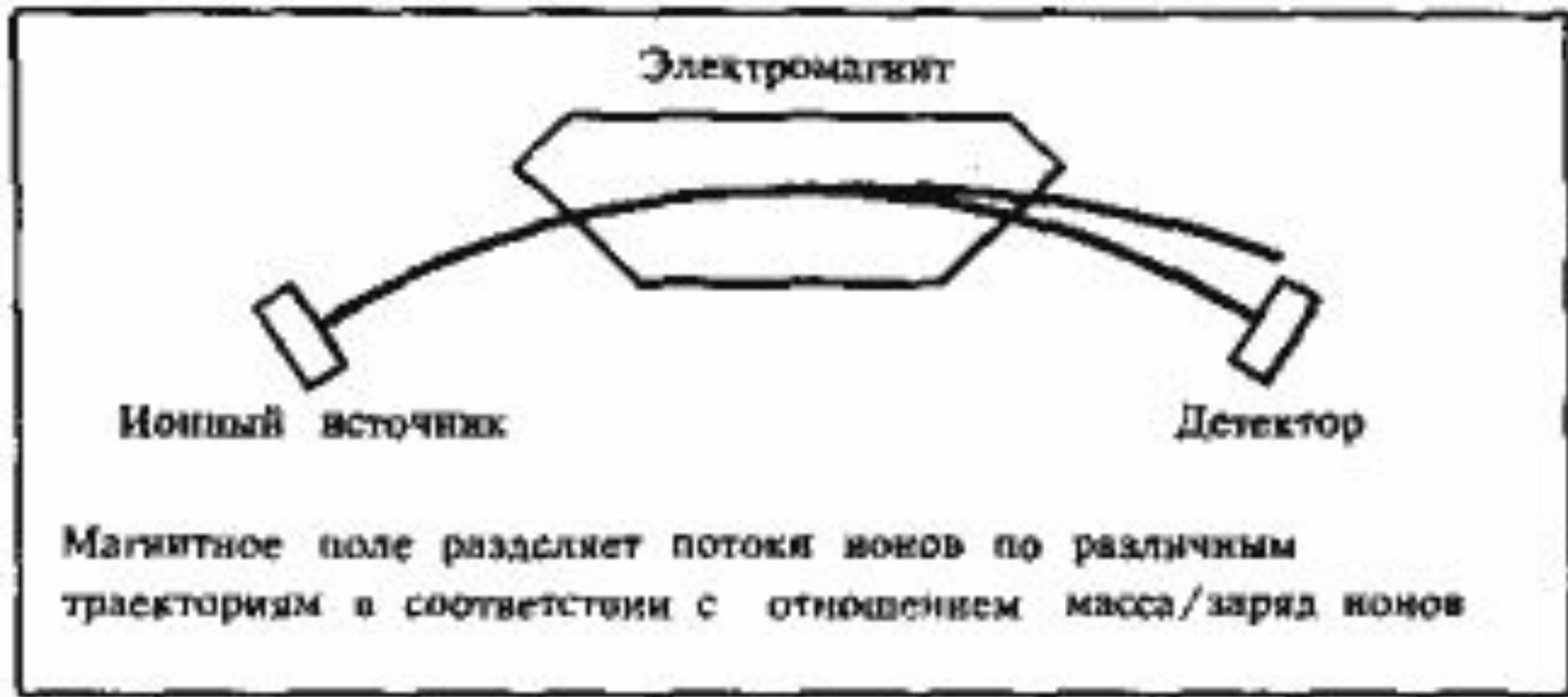
Принципиальная схема масс-спектрометра
