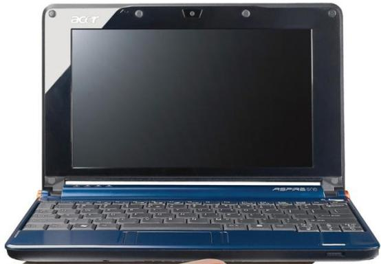
**Нетбук** — субноутбук с относительно невысокой производительностью, предназначенный в основном для выхода в интернет. Обладает небольшой диагональю экрана в 7—10 дюймов, низким энергопотреблением, небольшим весом и относительно невысокой стоимостью.
