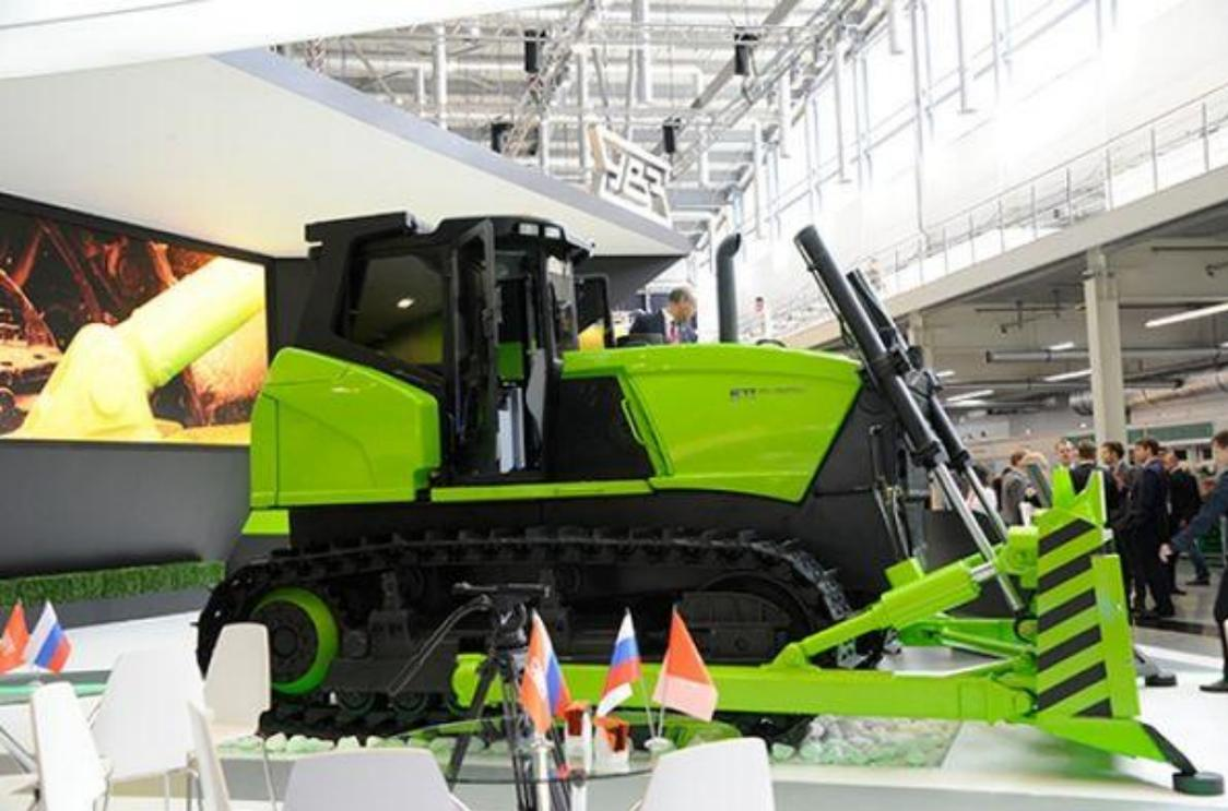
Корпорация «УВЗ» продемонстрировала на выставке пример плодотворного сотрудничества российского и китайского производителей. Представленный бульдозер Б11.8000 оснащен силовым блоком китайской корпорации «Shandong Heavy Industry Group» и входящих в ее состав компаний. На этой машине установлены двигатель «WeiChai» и гидромеханическая трансмиссия «Shantui».
