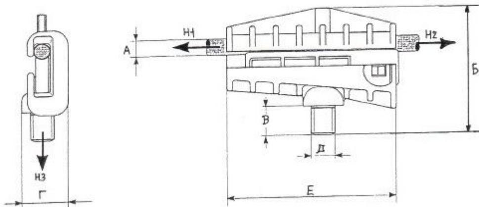
1. Корпус (сплав алюминия); 2. Клин (полиамид с добавкой стекловолокна)
