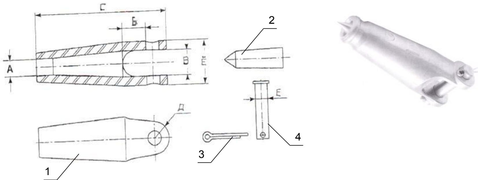
1. Корпус (сплав алюминия);
