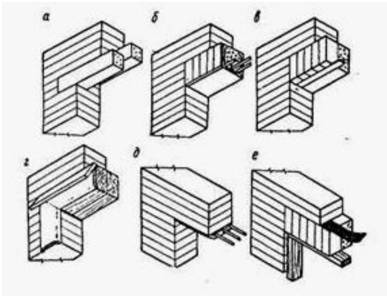
**а – железобетонная; б – железобетонная монолитная с облицовкой керамической плиткой; в – кирпичные по металлическому уголку; г – деревянная брусковая; д – из стальных арматурных стержней; е – кирпичная с арматурной сеткой.**
