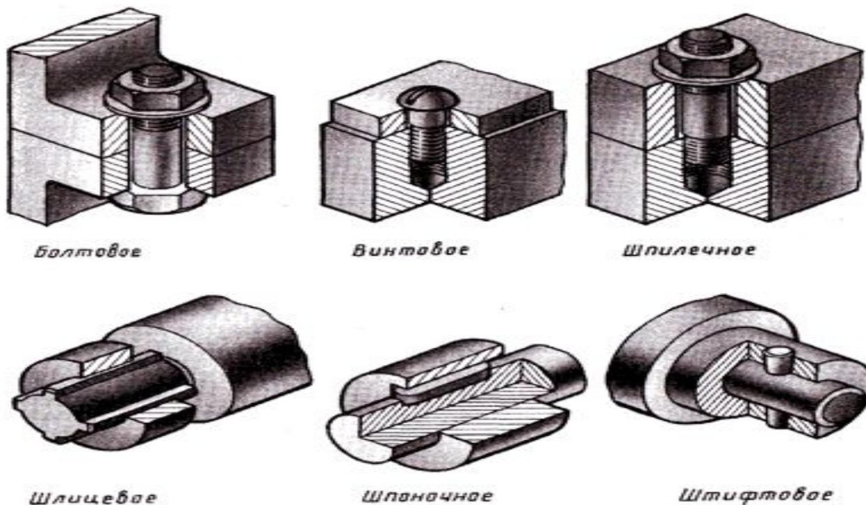
Рис. 202. Разъемные соединения
