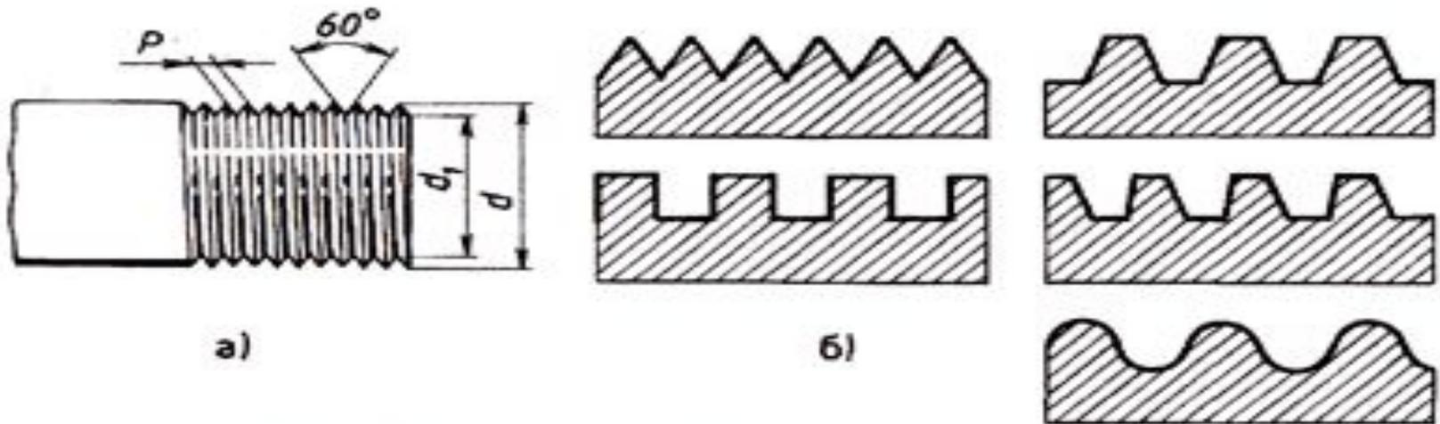
Рис. 206. Параметры резьбы и ее профили
