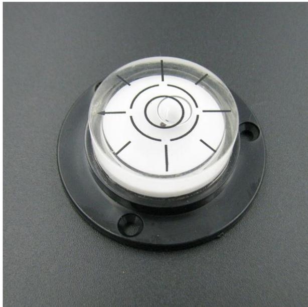
Круглые уровни служат для грубой, предварительной установки прибора в рабочее положение. Их точность часто значительно ниже точности рабочих цилиндрических уровней, используемых в том же приборе для точной установки осей.
