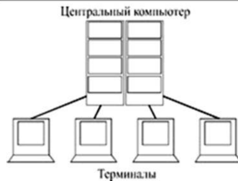
Рис. 1.1. Подключение терминалов к центральному компьютеру
