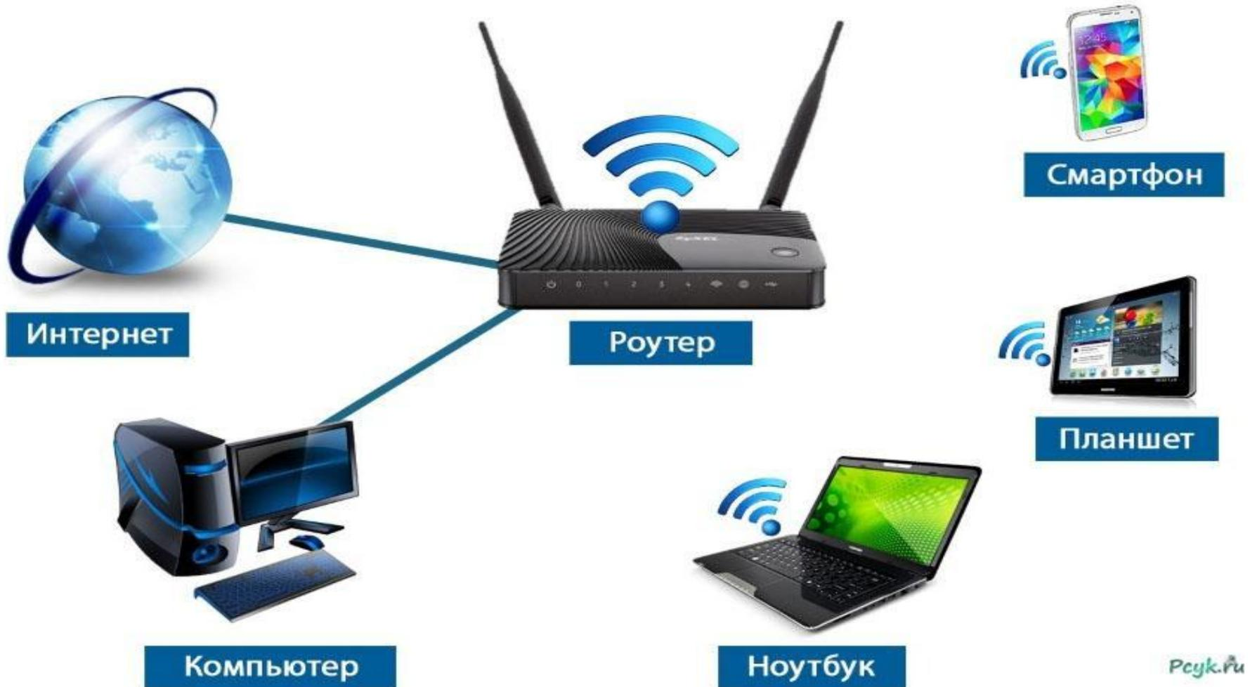
**Роутер (от англ. router), межсетевой шлюз, интернет шлюз — активное сетевое устройство, необходимое для соединения компьютерных сетей, имеющих различные настройки**
