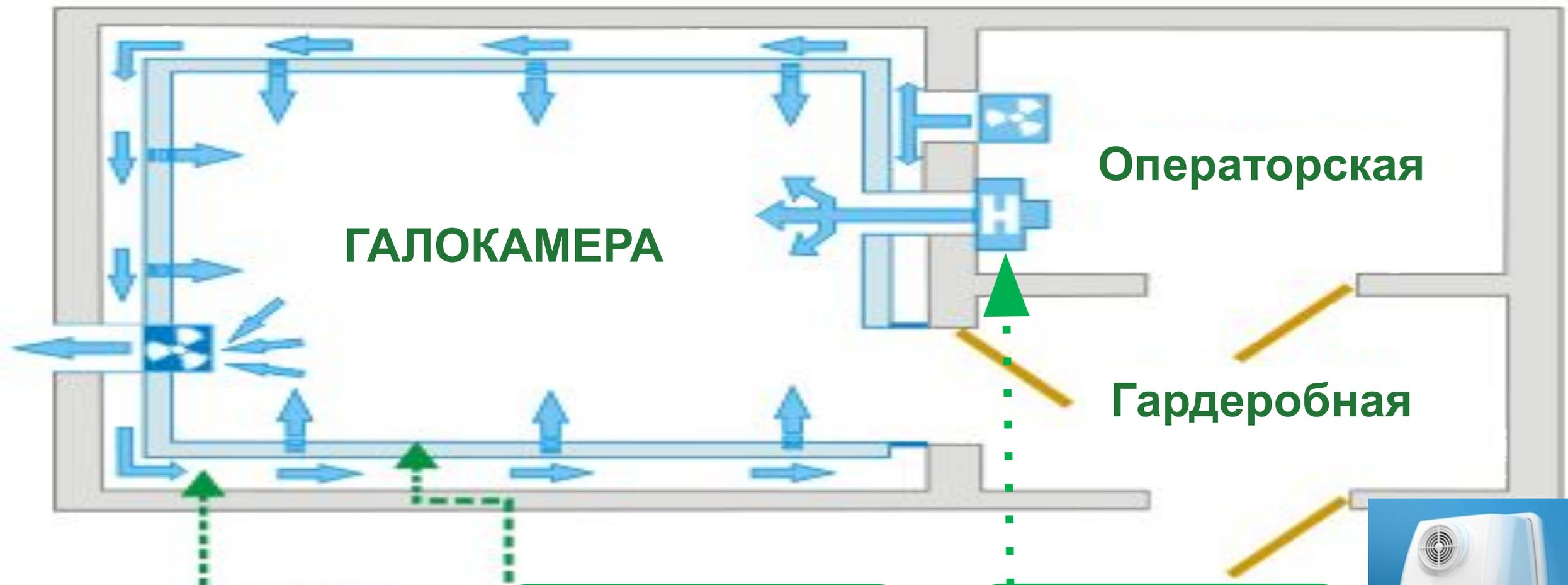
Вентиляционная камера служит для равномерной подачи воздуха по всей внутренней поверхности стеновых пористых соляных блоков
