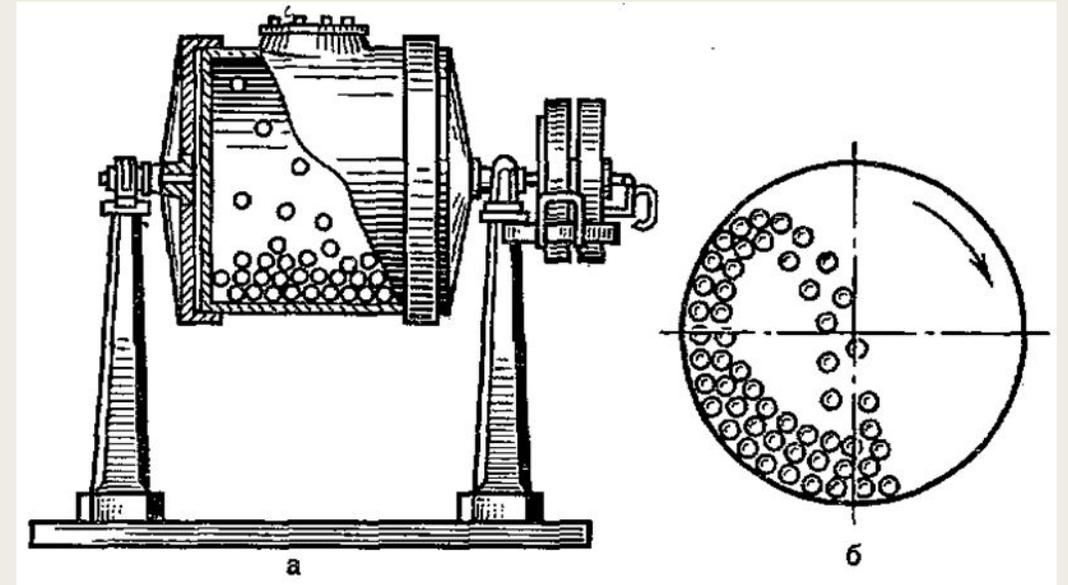
А – устройство шаровой мельницы
