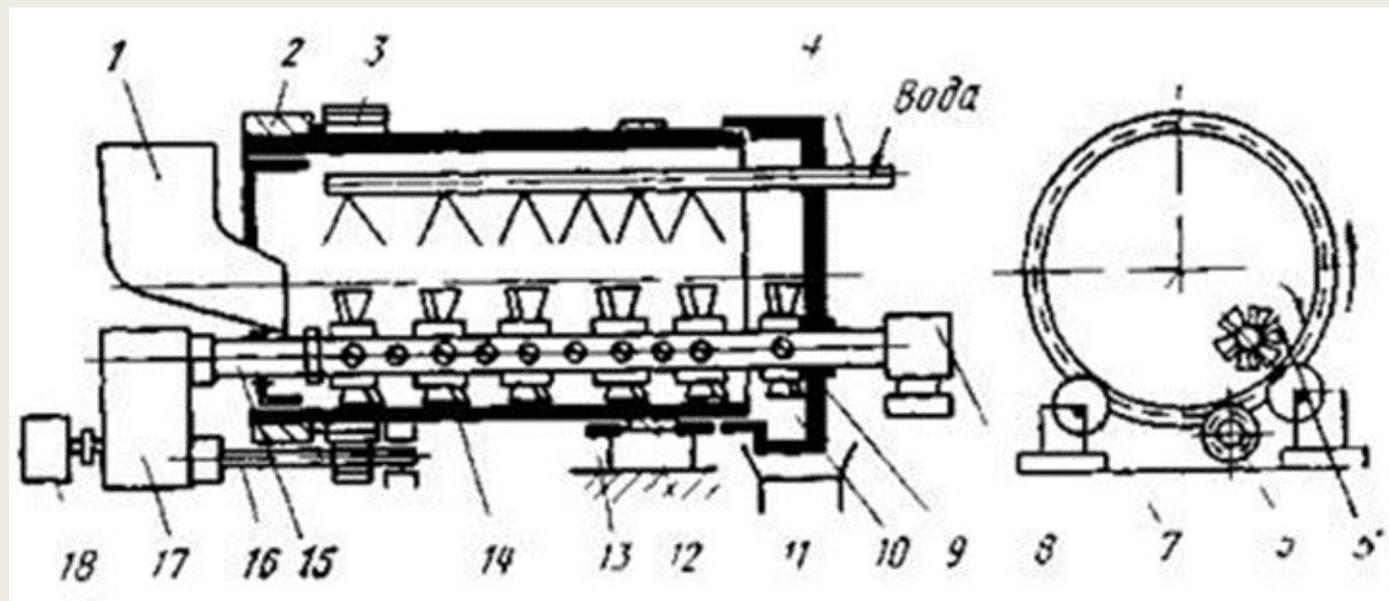
В передней торец смесителя через загрузочную воронку 1 подаются компоненты. Перемешанный готовый порошок выдается через неподвижную разгрузочную камеру 10 с торцевой стенкой 9 в воронку 11.
