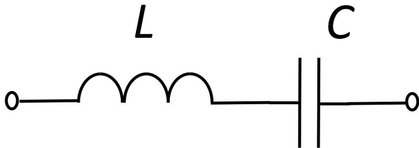
Последовательный колебательный контур
