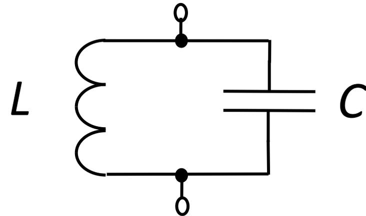
Параллельный колебательный контур
