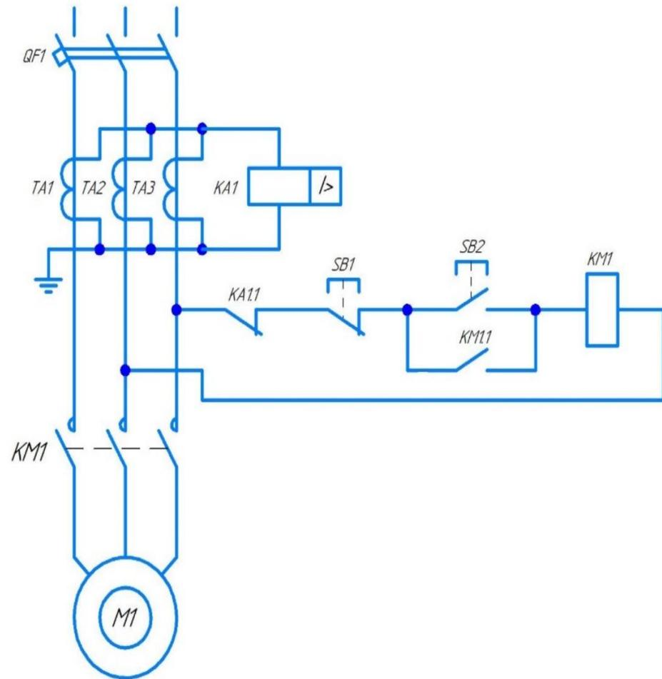
При однофазном замыкании на землю геометрическая сумма токов во вторичной обмотке ТМП нарушается из-за чего активируется реле тока КА1. Контакт КА1.1 размыкается, тем самым не довая запустить двигатель
