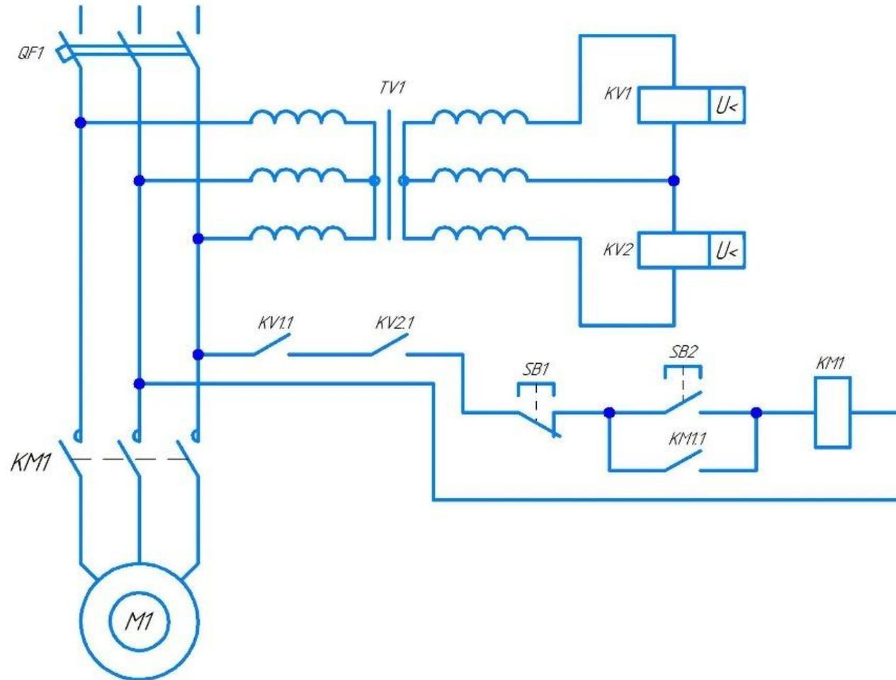
При нормальной работе контакты KV1.1 и KV2.1 замкнуты, а при обрыве фазы разомкнуты и не дают запустить двигатель.
