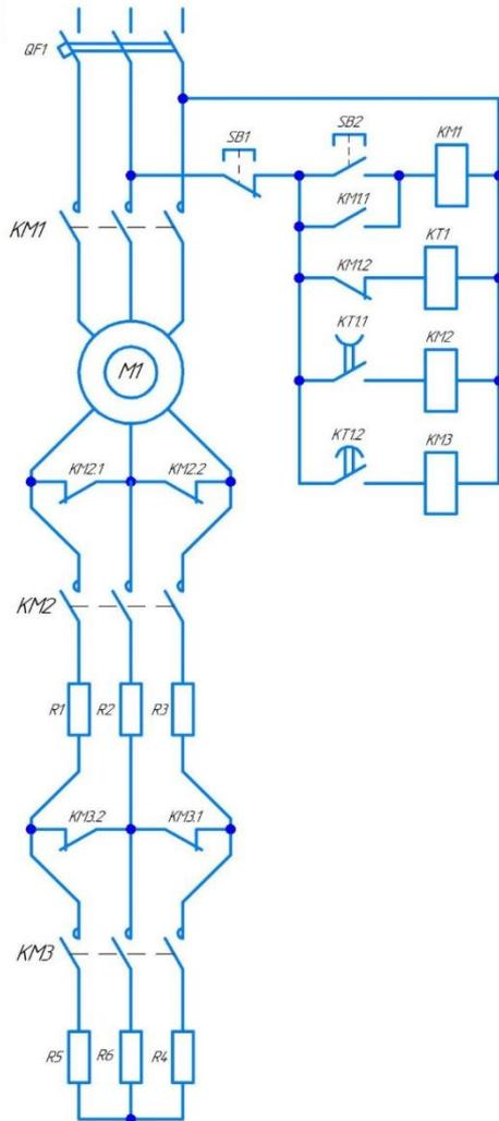
При нажатии на кнопку SB1 будет происходить торможение двигателя при помощи добавочных сопротивлений
